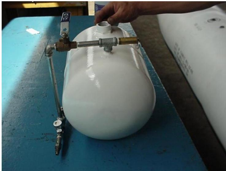
Figura 3.3. Sistema Neumático instalado en el tanque.
