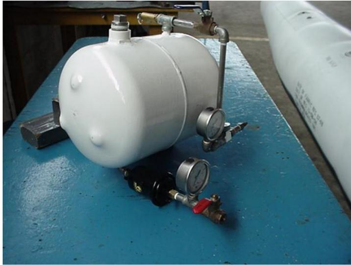
Figura 3.5. Sistema Hidráulico instalado en el tanque.
