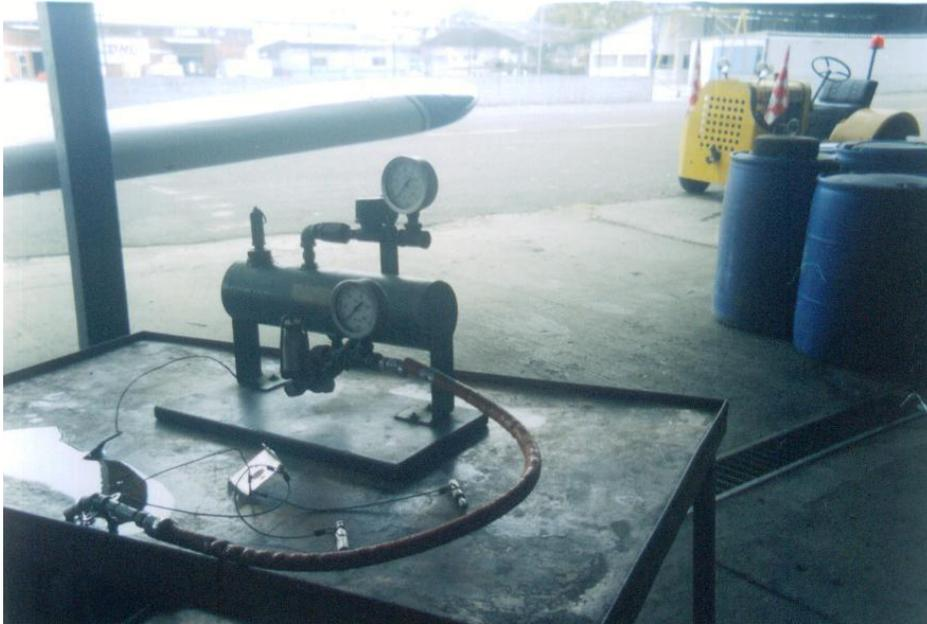
Figura 1.7. Banco de Pruebas de Inyectores a presión neumática.
