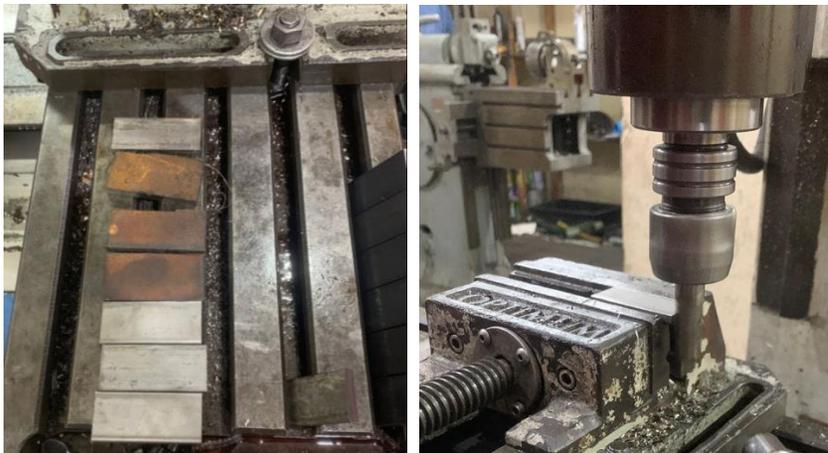
Una vez que las probetas se encuentran dimensionalmente satisfactorias, se realizará un pulido fino en una de las superficies laterales de modo que, el acabado tipo espejo resultante de este procedimiento, permita observar con mayor claridad y sin discontinuidades el resultado del ensayo en cuestión. El *Anexo A-7* detalla todo el procedimiento de mecanizado.
