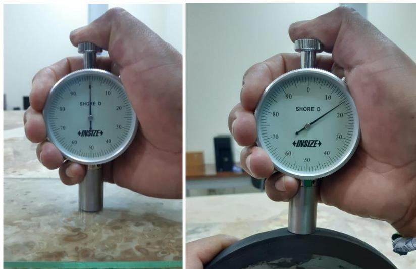
En la *Tabla 20* se muestran los valores medidos de dureza en escala SHORE Tipo D y su respectiva conversión a la escala SHORE Tipo A.
