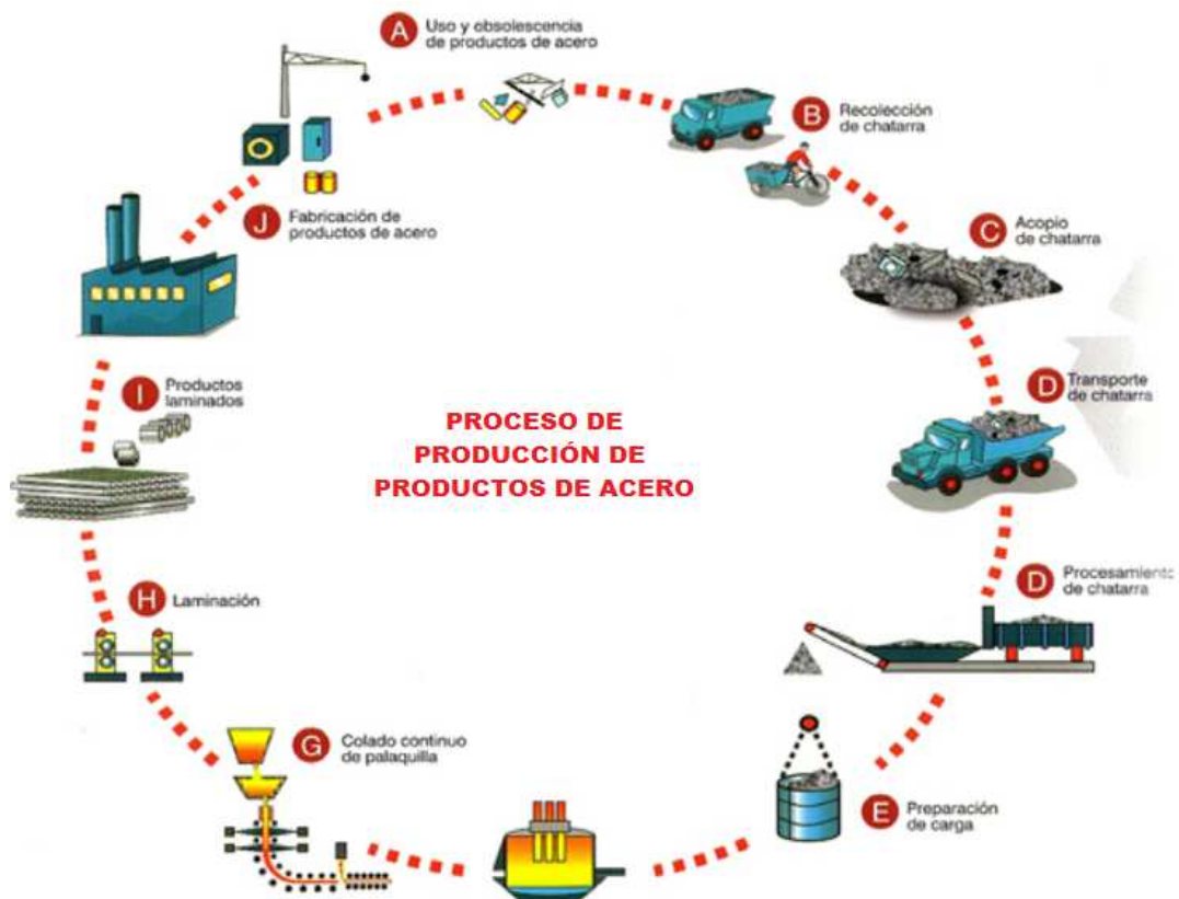
Gráfico No. 65: Proceso de Producción de los Productos de Acero
