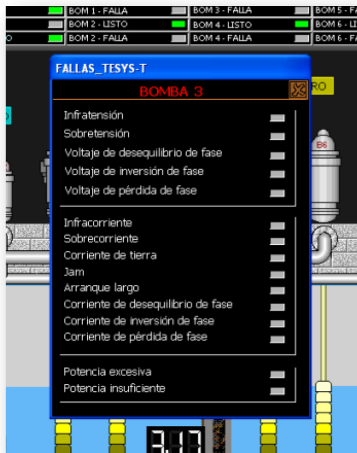
Gráfico 9.25 SCADA – Control de Fallas de TeSys T
