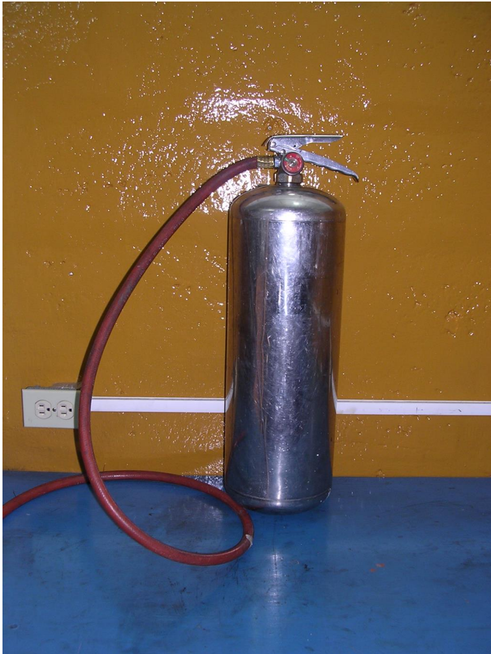
Figura 3.1 Botellón para lavado de compresor.
