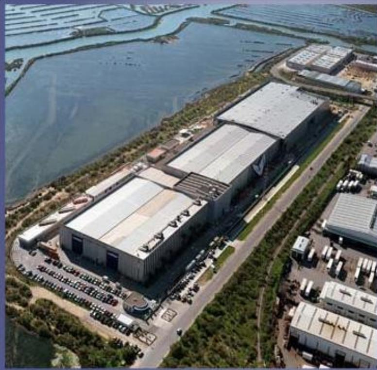
En planta de Puerto Real se manejan y ensamblan componentes estructurales para el sistema de Rudder del A380. La planta también es responsable de la producción de la Belly Fairing (Carena Ventral), junto con el ensamblaje y test funcional final del estabilizador horizontal. Puerto Real es el puerto de salida de los componentes hechos en España hacia la planta de ensamblaje en Francia.
