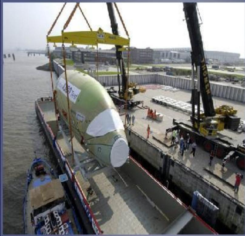
...fuselaje, que contiene la cabina de pilotaje, se ensambló en Méaulte antes de ser llevada por vía terrestre y aérea... utilizando el A300-600 ST Super Transporter ("Beluga") a St Nazaire para incorporarla a la sección delantera del fuselaje y de ahí ser transportada por el ferry conocido como "roll-on, roll-off" hasta llegar a Su destino final, la factoría de Toulouse-Blagnac.
