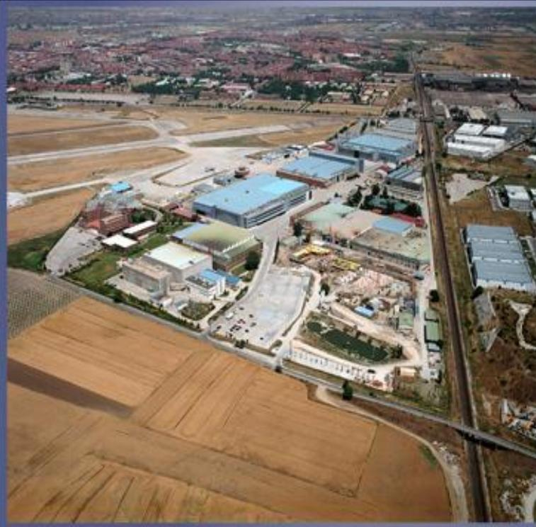
La planta de Getafe se ha especializado en la ingeniería del diseño de componentes de aeronave con materiales compuestos pioneros en la industria. Para el A380 la planta produce las cajas laterales del plano horizontal de cola, las puertas del tren principal, secciones traseras del fuselaje y el dorsal del estabilizador vertical.
