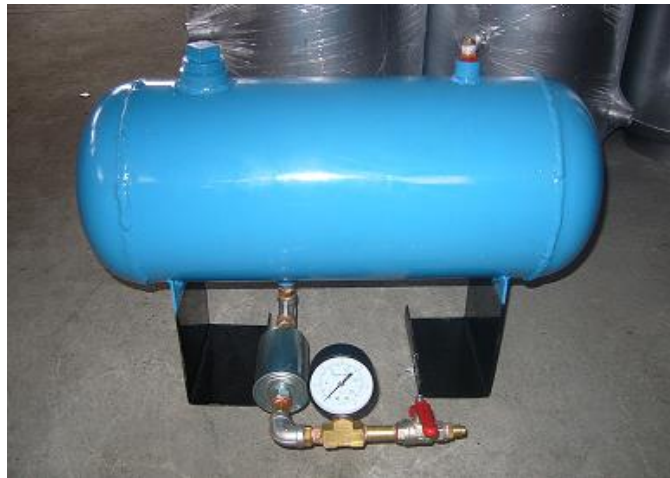
Figura 4.6. Sistema de Combustible instalado en el tanque.
