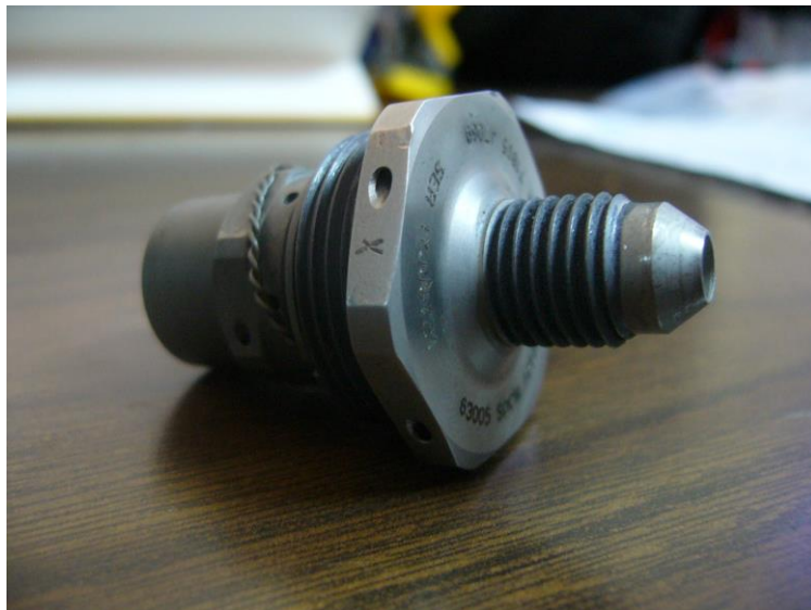
Figura 2.2. Inyector de combustible del motor ALLISON 250-C20J.
