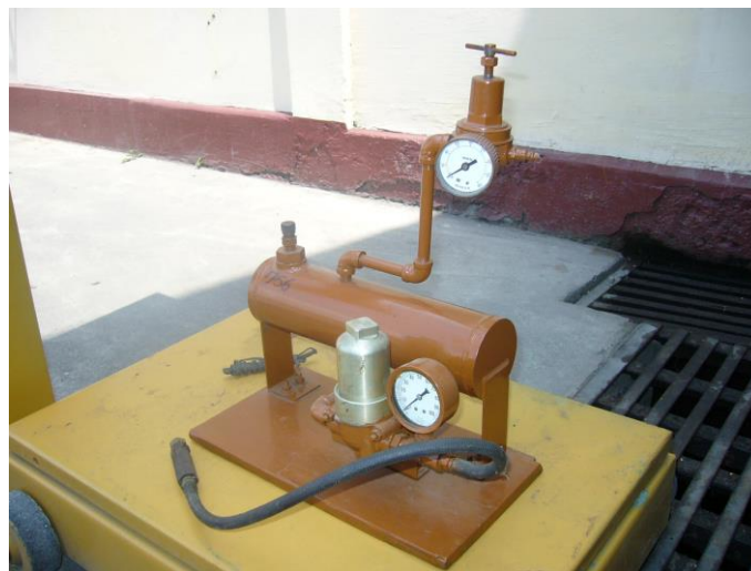
Figura 2.11. Banco de Pruebas de Inyectores a presión neumática.
