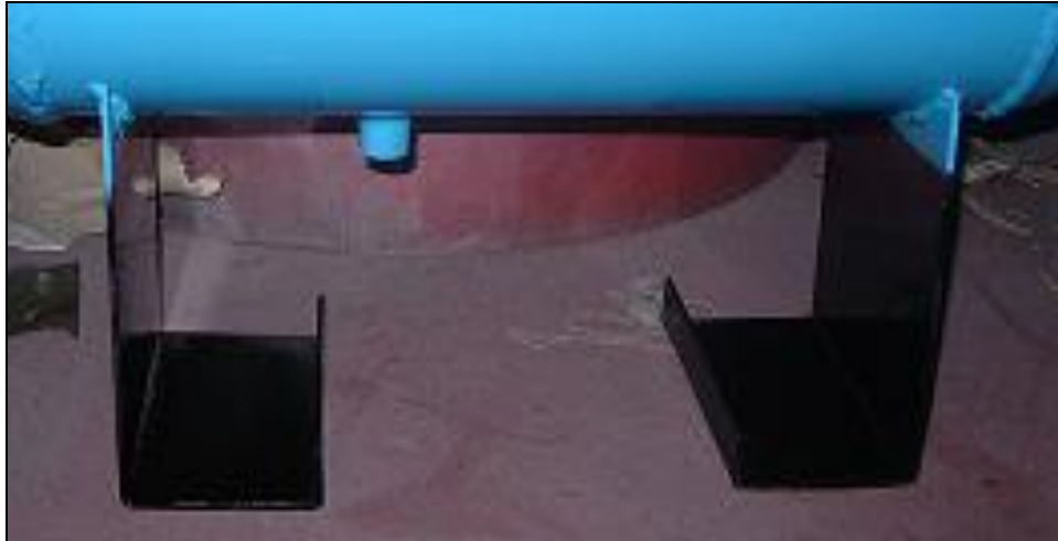
Figura 4.4. Base del banco de prueba de inyectores.
