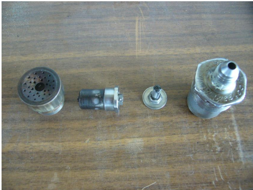
Figura 2.6. Inyector del motor Allison 250-C20J desarmado.
