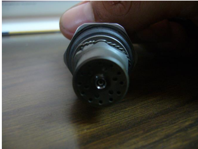
Figura 2.4. Inspección del inyector.
