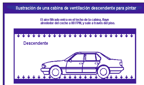
Figura 2.2 Cabina de pintura tipo flujo vertical
