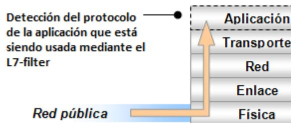
Figura. 1. 25. Filtrado de Datos en la capa de aplicación.
