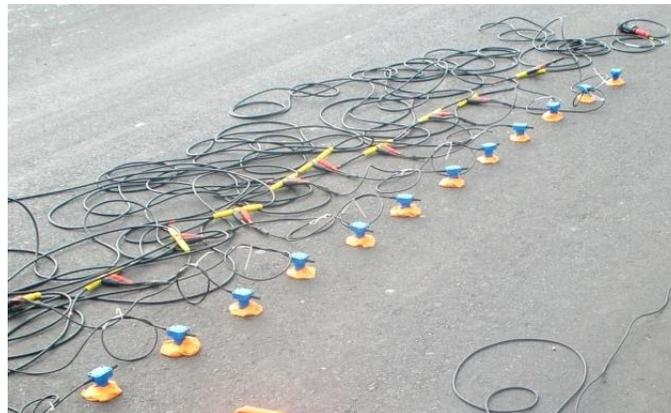
**Figura 4.13** Los golpes se realizan al inicio y al fin de la línea sísmica.
