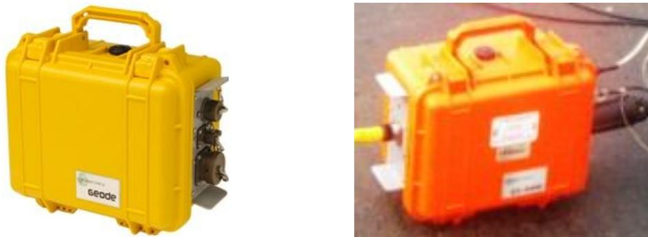
**Figura 4.1** Geode sismógrafo de exploración Ultra Ligero
