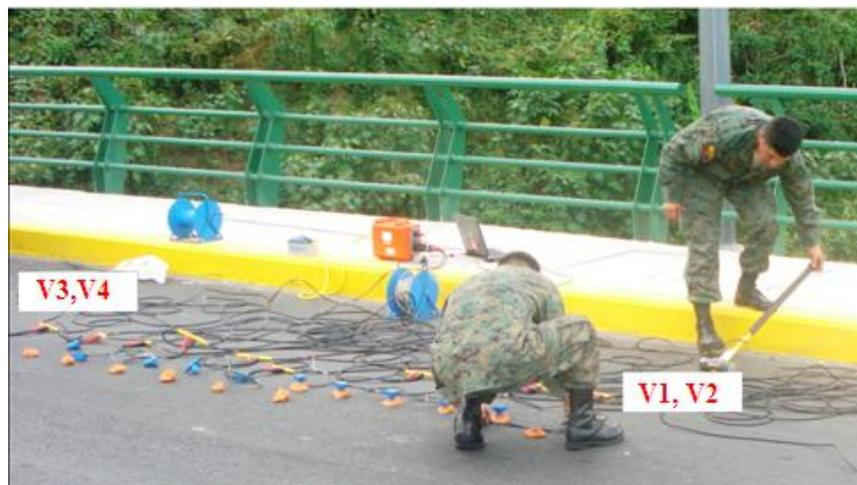
**Figura 4.19** Dos golpes por extremo de line sísmica
