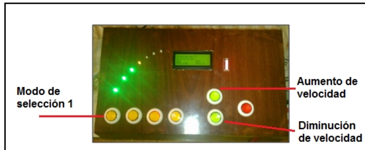
Figura. 6. 7 Tablero de control modo de selección 1
