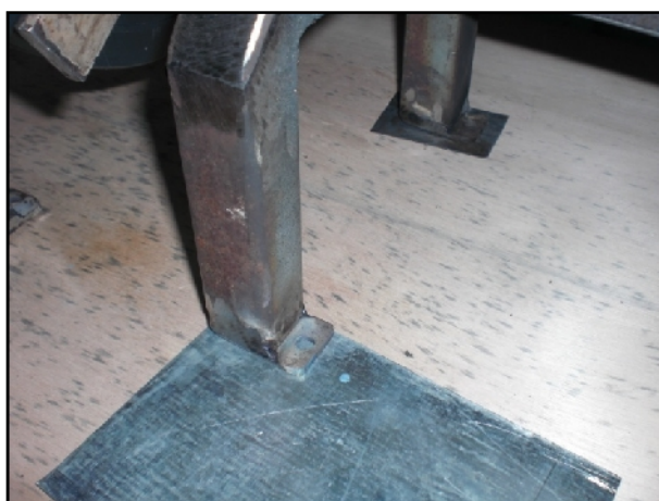
Figura. 5. 15 Nivelación de altura entre elementos
