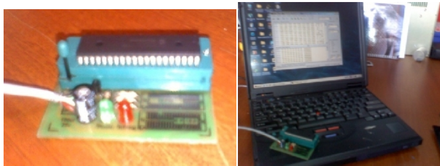
Figura. 4. 23 Quemador serial para PICs y Utilización de Programas Microcode e IC-PROG para programar y Grabar en PIC
