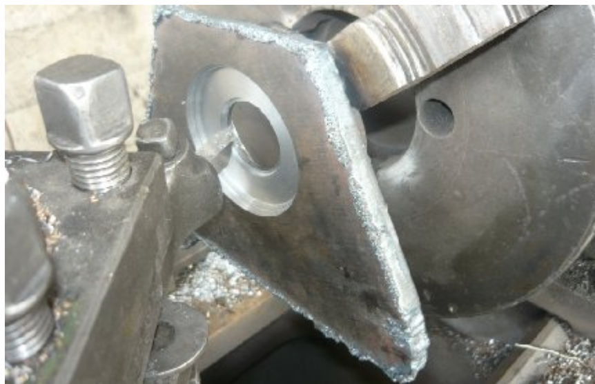
Figura 3.4 Construcción Del soporte de Caliper
