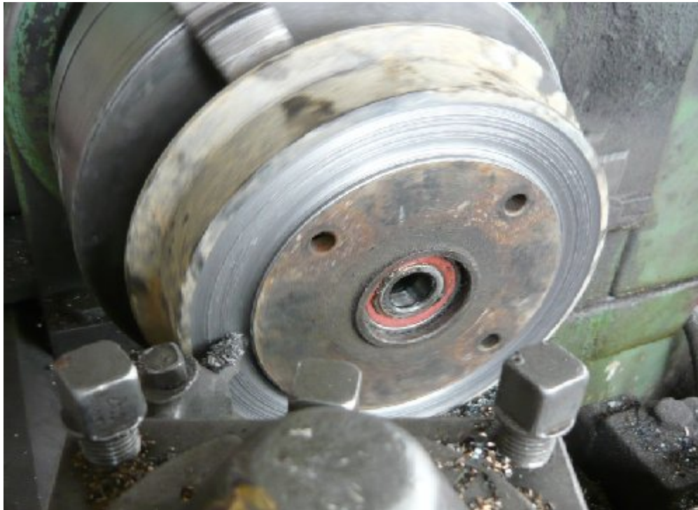
Figura 3.6 Extracción de la Manzana del Tambor de Freno
