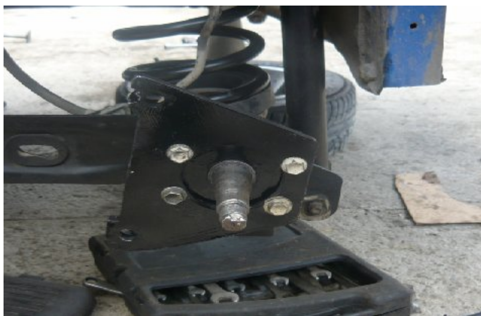
Figura 3.5 Base de Caliper Instalada
