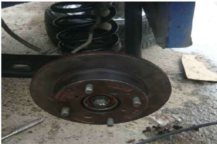
Figura 3.10 Ensamble del disco de Freno en el Eje Posterior
