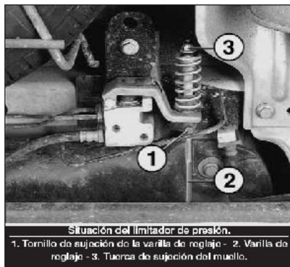
Figura 1.26 Válvula Limitadora de Frenado
