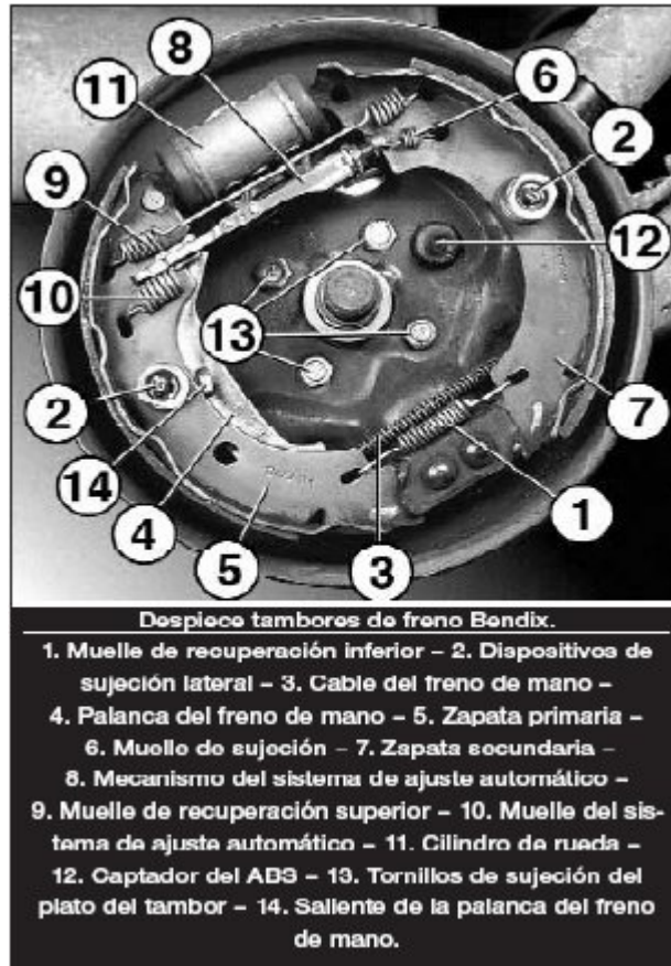
Figura 1.7 Freno de Tambor Sistema Bendix
