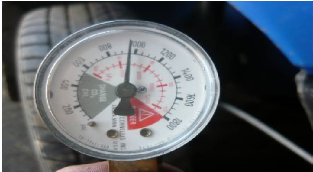
Figura 4.1 Medición de Presión en la Rueda Delantera
