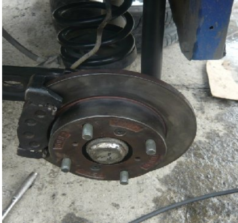
Figura 3.11 Instalación de los Calipers
