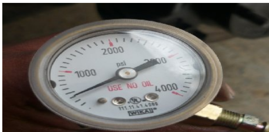
Figura 4.2 Medición de la Presión en la Rueda Posterior
