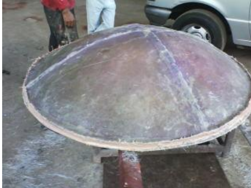
Figura 4.5. Concentrador en fibra de vidrio
