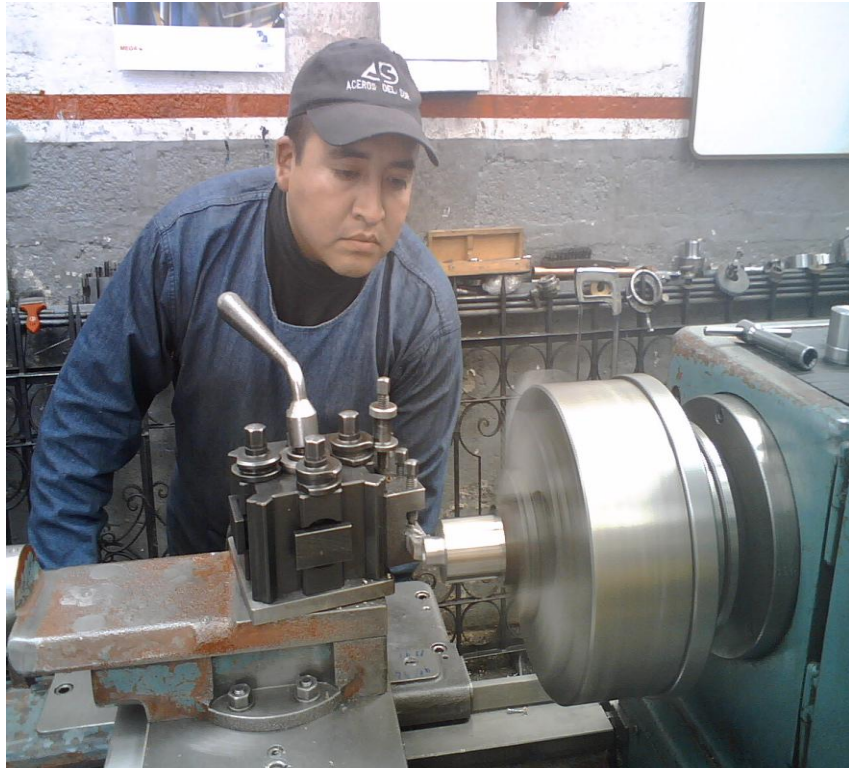
Figura 4.13. Maquinado del bronce fosforito
