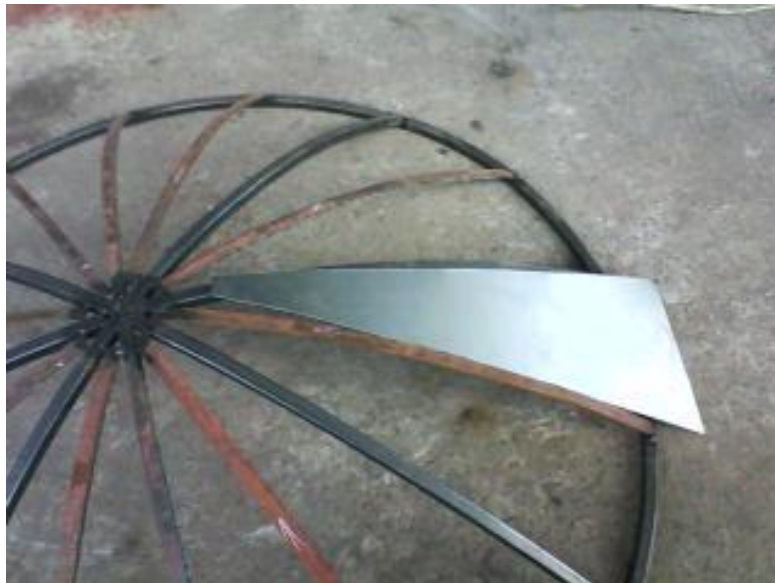
Figura 4.2. Planchas de tol para el molde
