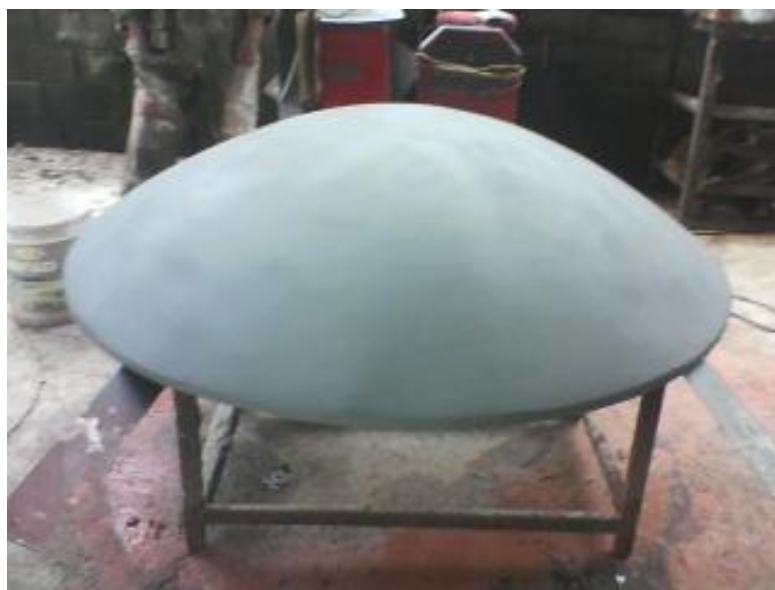
Figura 4.4. Molde del concentrador
