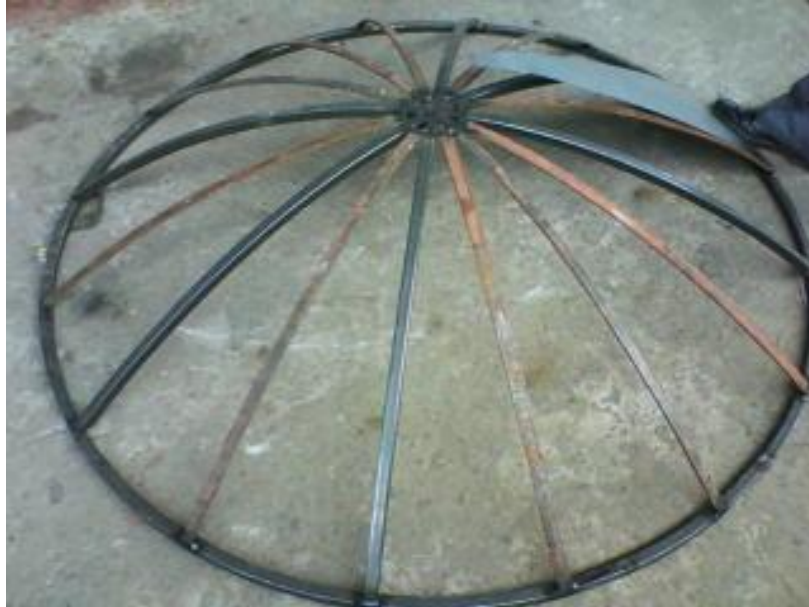
Figura 4.1. Construcción del molde
