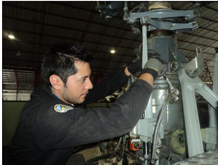
Figura 31 Instalación Tubería Hidráulica 1
