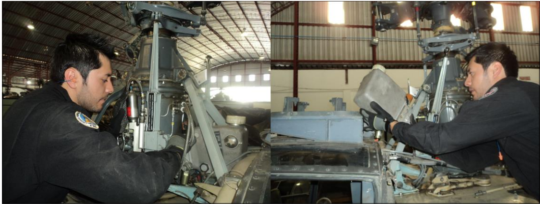
Figura 43 Desmontaje block hidráulico
