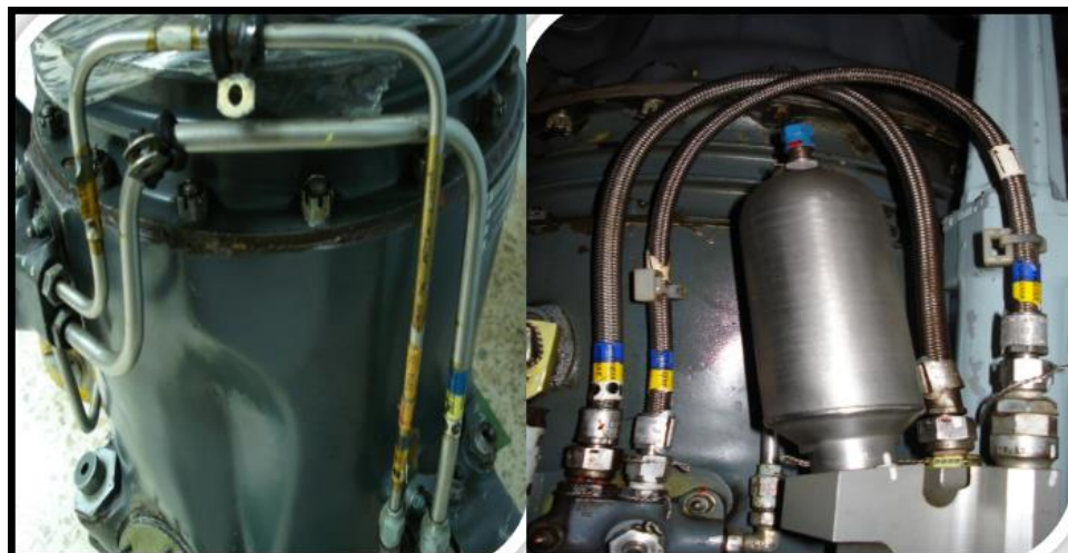
Figura 20 Tuberías Rígidas y Flexibles
