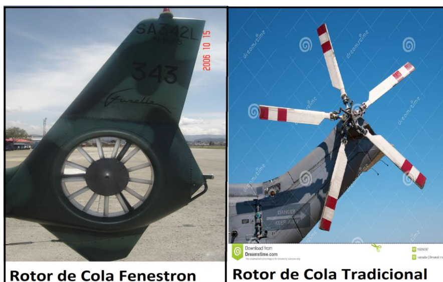
Figura 2 Rotor Fenestron y Rotor tradicional
