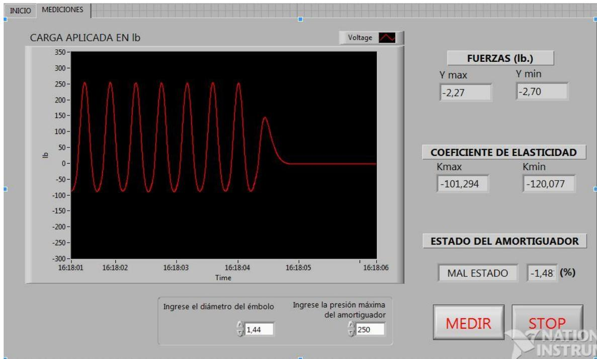
Figura 5.2 diseño de la pantalla de mediciones.
