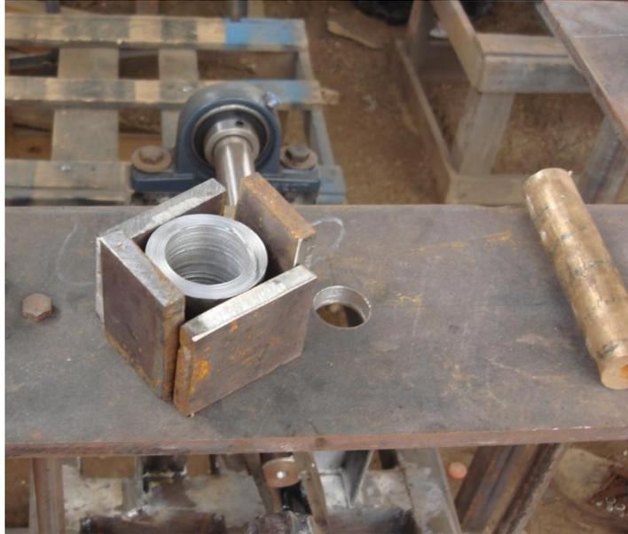
**Figura 4.12. Bujes en Construcción**
