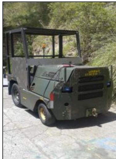
Figura 54. Recubrimiento de la cabina de protección
