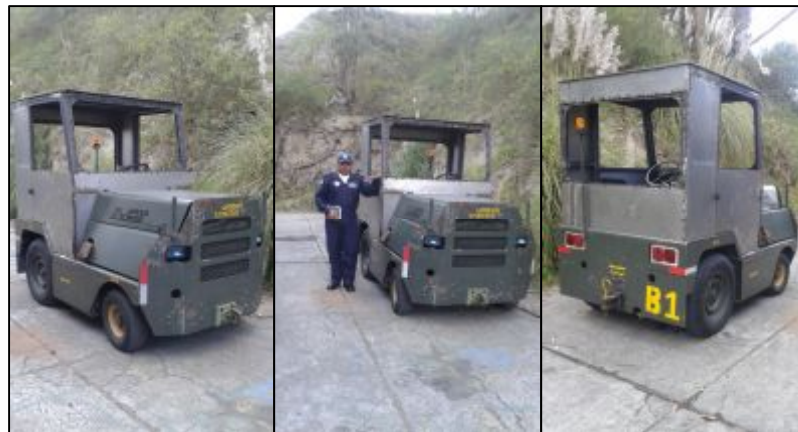
Figura 58. Estructura de la cabina después del proceso de desbaste
