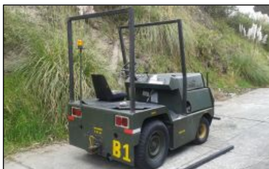
Figura 51. Montaje de las columnas en el equipo
