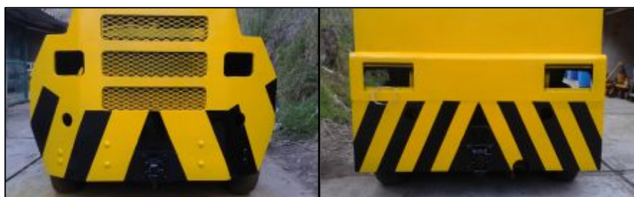
Figura 62. Líneas de seguridad frontal y posterior
