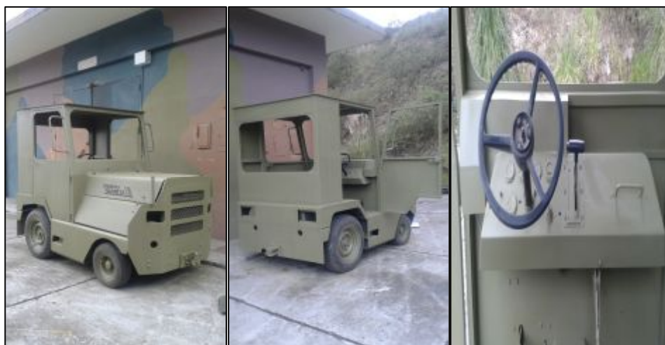
Figura 60. Proceso de dar fondo al Equipo Remolcador
