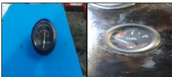
Figura 71. Medidor de combustible (antes-después)
