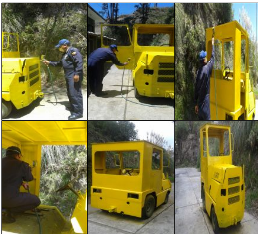
Figura 61. Proceso de pintura del Equipo Remolcador
