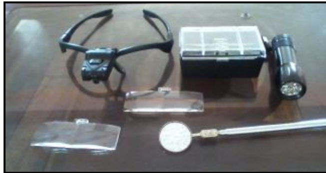
Figura 30. Accesorios de inspección visual
