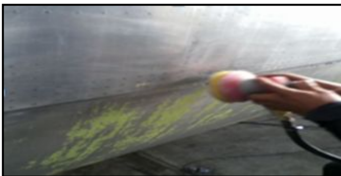
Figura 90. Suabizado del dent
