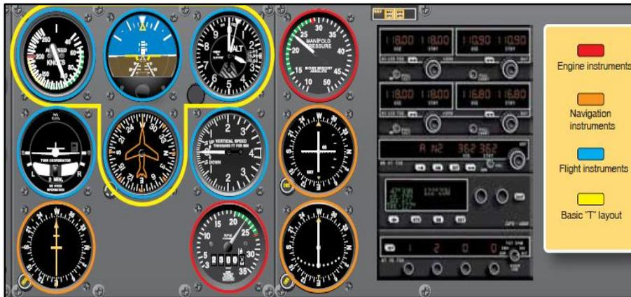
**Figura 4.** Instrumentos de navegación
