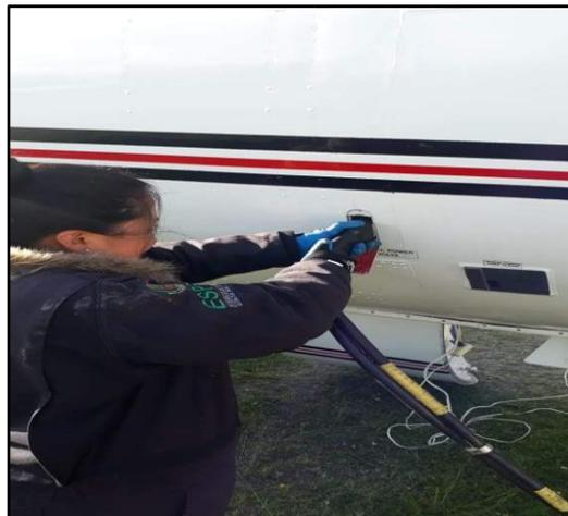
**Figura 26.** Conexión del GPU
