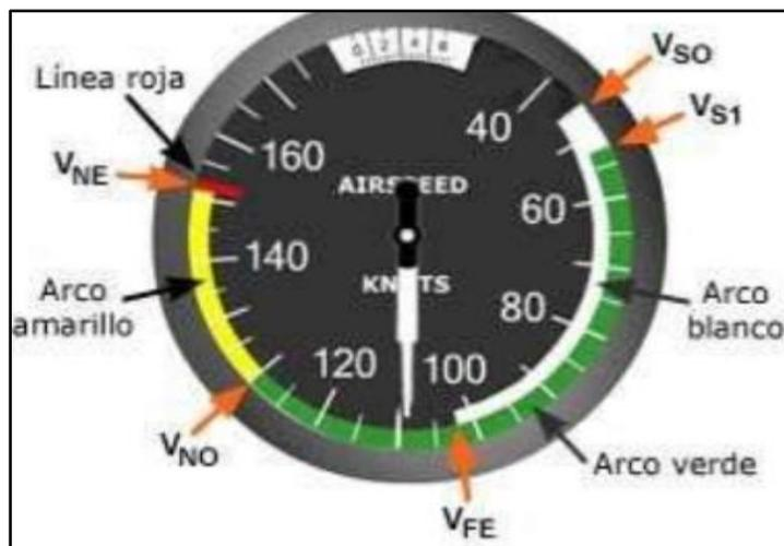
**Figura 17.** Indicador de velocidad de aire
