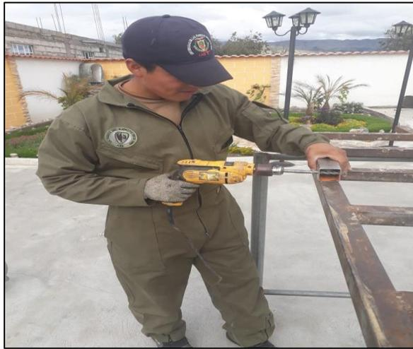
**Figura 31.** Perforaciones para la unión de elementos
