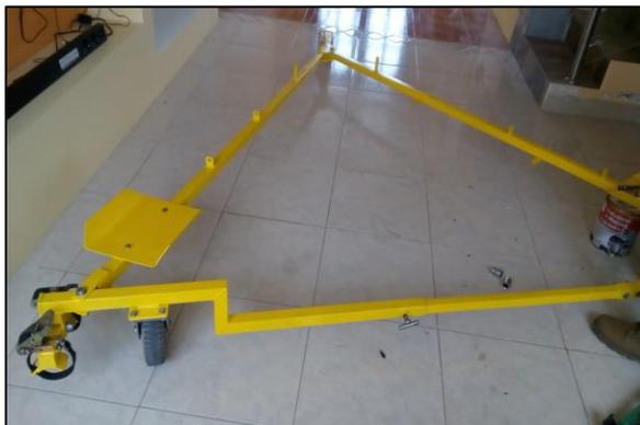
**Figura 36.** Ensamblaje de la barra de remolque
