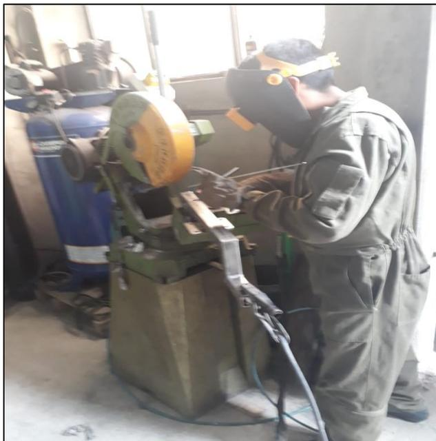
**Figura 29.** Unión por suelda TIG
