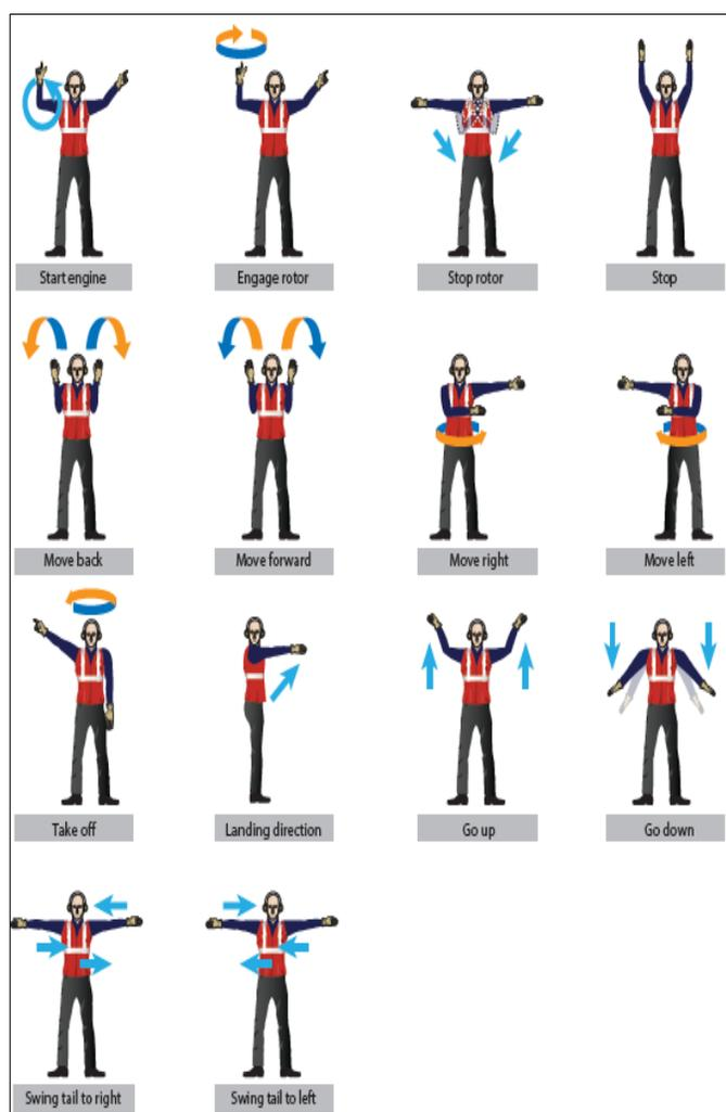
**Figura 12.** Señales de operación para un helicóptero
