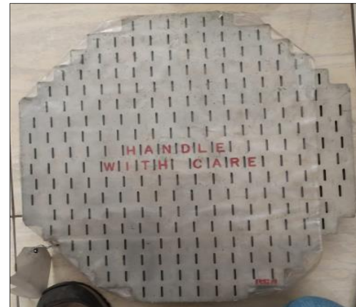
Antena del Radar
