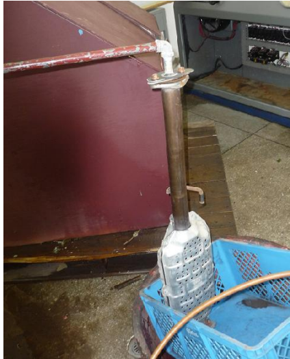
Figura 3.14 Montaje de la bancada y el convertidor catalítico
