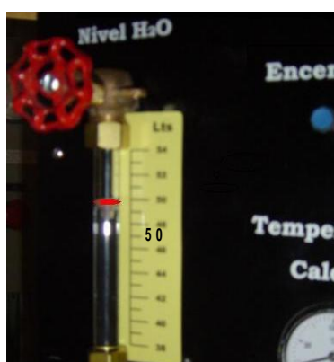
Figura 3.12 Nivel de agua de operación normal de la caldera
