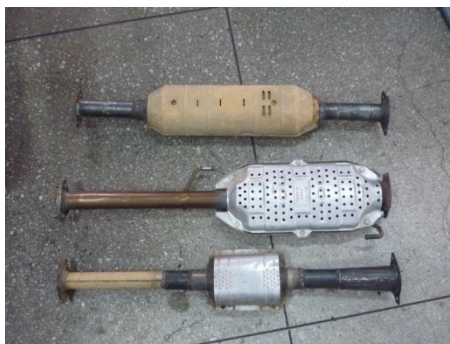
Figura 3.5 Catalizadores de prueba con las bridas soldadas
