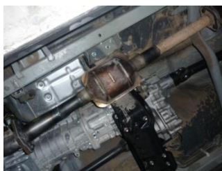
Figura 4.20 Montaje del catalizador regenerado en el vehículo
