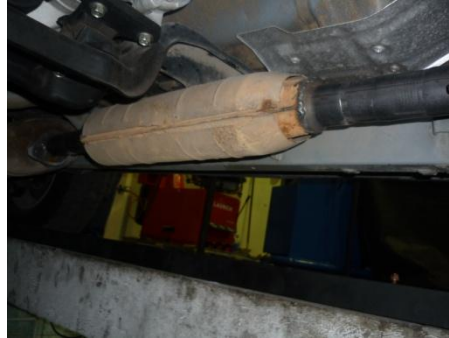
Figura 3.6 Colocación del catalizador de prueba en el vehículo
