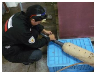
Figura 4.17 Montaje del catalizador en el Caldero
