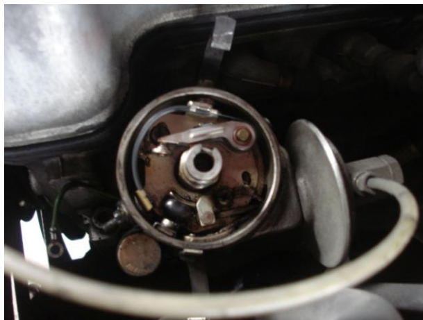
Figura 3.31: Distribuidor con platinos de dos piezas.
