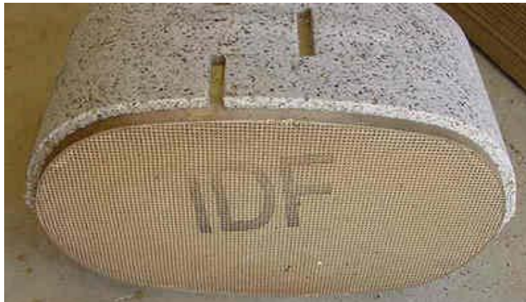
Figura 2.14: Estructura interna de un Catalizador. 13
