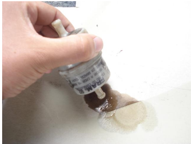
Figura 3.32: Cambio de filtro de combustible.
