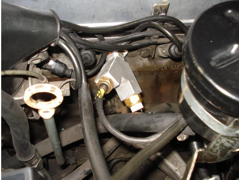
Figura 3.40: Instalación de Sensor de Temperatura en el Motor.
