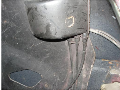
Figura 3.46: Depósito de expansión.
