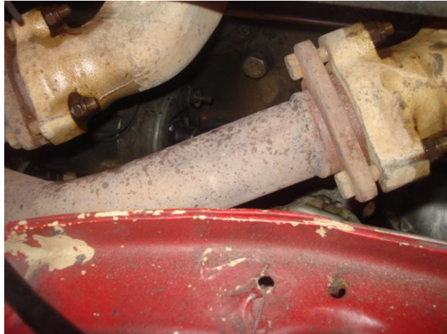
Figura 3.38: Salidas de los múltiplos de escape.
