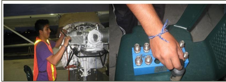
Figura 47. Instalación de Bujías
