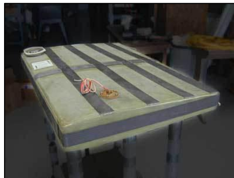
Figura 17. Tanque de combustible
