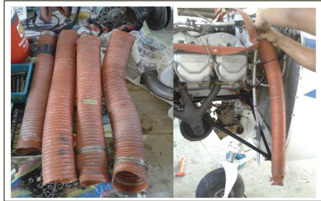
Figura 51. Conexión de ductos de Ventilación y Calefacción
