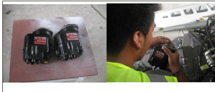
Figura 41. Instalación de Magnetos
