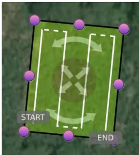
*Nota:* En la figura se muestra un ejemplo de los diseños de los vuelos realizados con el UAV DJI Phantom IV +Parrot Sequoia
