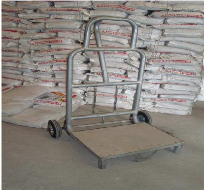
Figura 3.2 Equipo manual (carretilla de dos ruedas)
