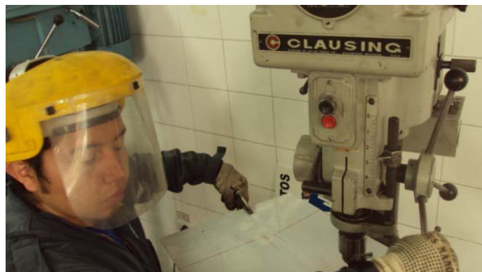
Figura 3.26 Taladrado de agujeros en las esquinas
