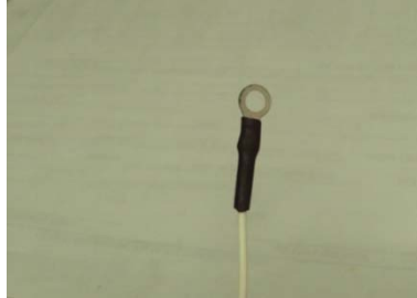
Figura 3. 5 Cable remachado y protegido con termo-contraíble
