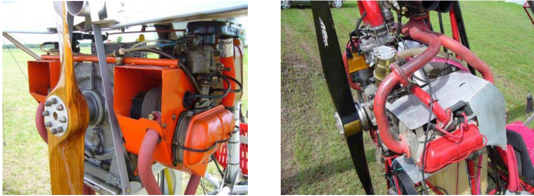
Figura 2.24 Fotos ductos deflectores de aire
