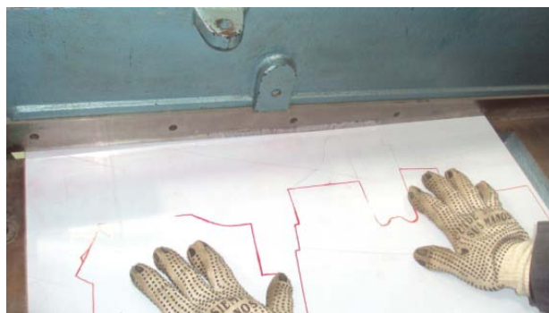
Figura 3.24 Cortado de lámina de acero Fuente: Investigación de Campo
