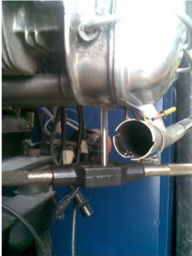
Figura 3.23 Roscado en el cabezote para anclaje de nacelas Fuente: Investigación de Campo
