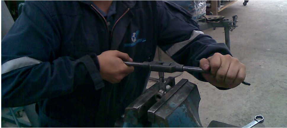
Figura 3. 9 Fotografía del Roscado para el bulbo de temperatura.
