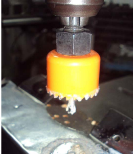
Figura: 3.31 Perforación con broca de campana
