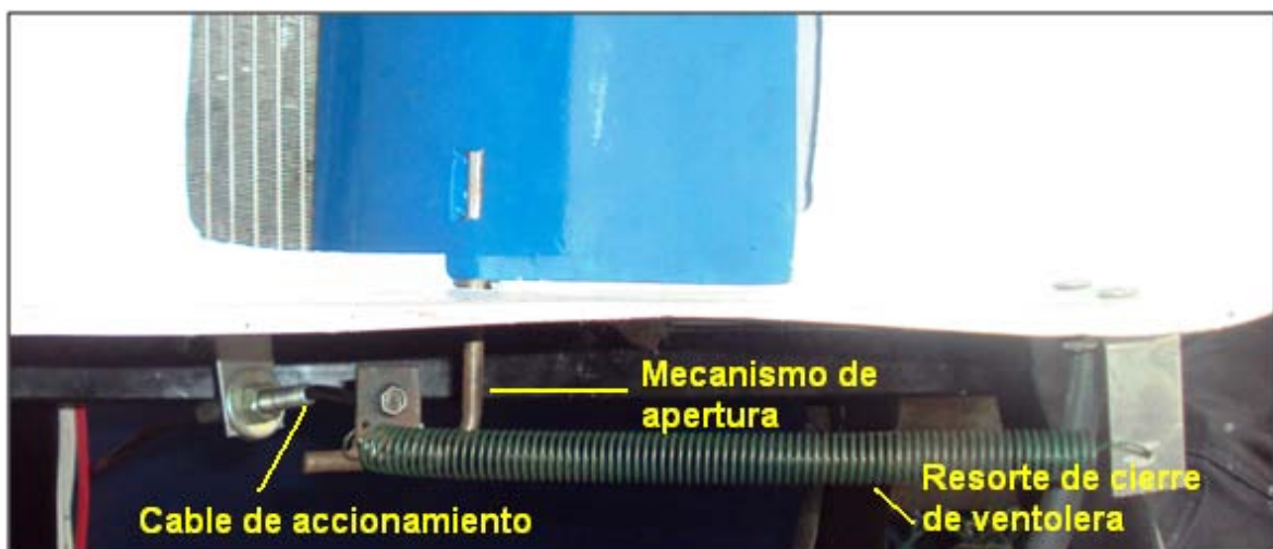
Figura 4: Detalle mecanismos de apertura de la ventolera
