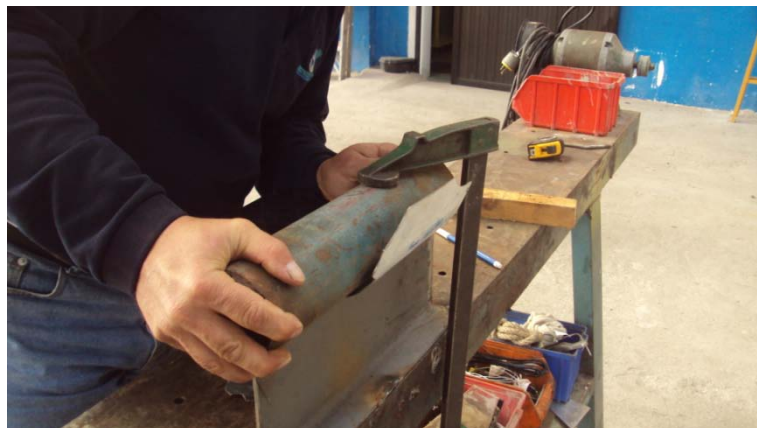
Figura 3.30 Doblado con radio de 33mm Fuente: Investigación de Campo
