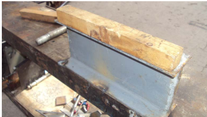
Figura 3.28 Dobladora improvisada para nuestro requerimiento Fuente: Investigación de Campo
