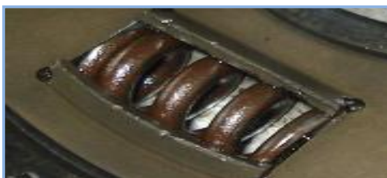
FIGURA 3.25 Verificación de Resorte Comprimido.
