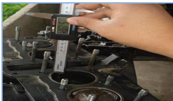
FIGURA 2.24 Medición de la Carrera del Pistón.
