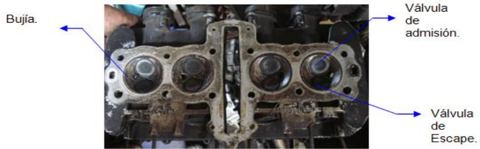
FIGURA 2.7 Cámara de Combustión KZ 550. FUENTE: Fernando Farinango - Investigador.
