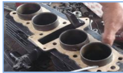
FIGURA 2.21 Elaboración del Empaque para el Bloque de Cilindros.
