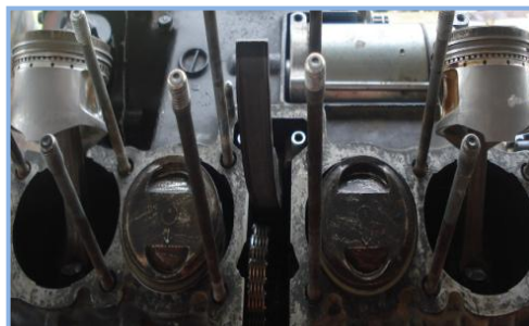
FIGURA 2.22 Instalación de Pistones en las Bielas.
