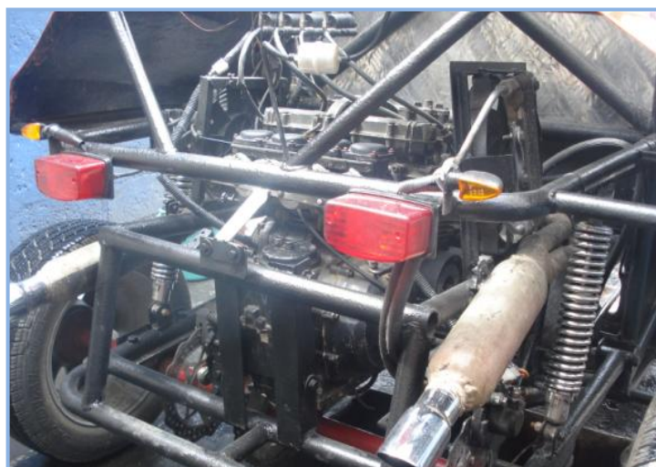
FIGURA. 4.38 Tren de Potencia Adaptado a Prototipo. FUENTE: Fernando Farinango - Investigador.
