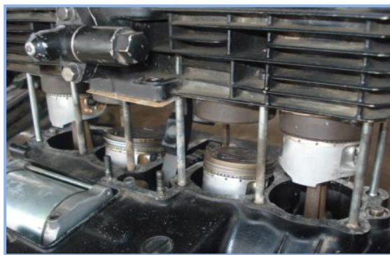
FIGURA 2.23 Instalación del Bloque de Cilindros.
