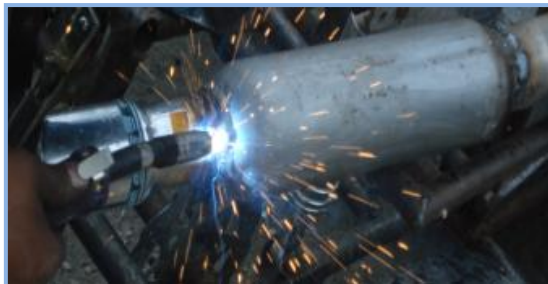
FIGURA 2.43 Instalación del Resonador. FUENTE: Fernando Farinango - Investigador.
