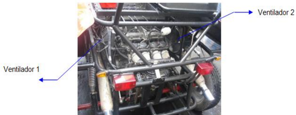
FIGURA 2.32 Ubicación de los Ventiladores.
