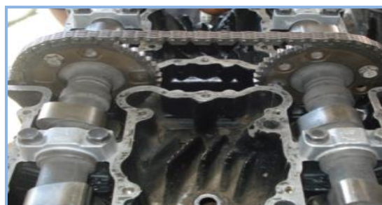
FIGURA 2.28 Instalación de la cadenilla de distribución.
