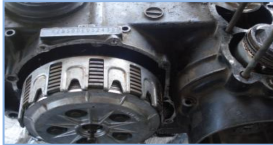
FIGURA 3.28 Embrague Instalado en el Motor.
