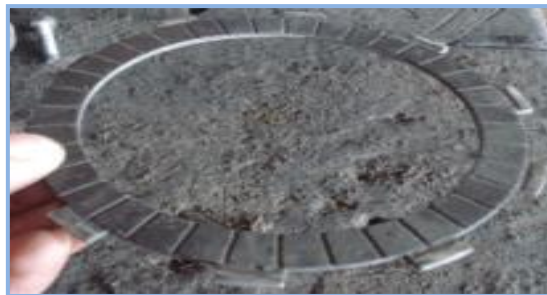
FIGURA 3.24 Verificación de Cualquier Tipo de Deformación. FUENTE: Fernando Farinango - Investigador.
