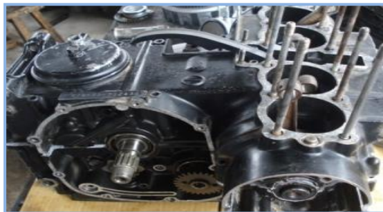
FIGURA 2.19 Fijación del cigüeñal y la transmisión.
