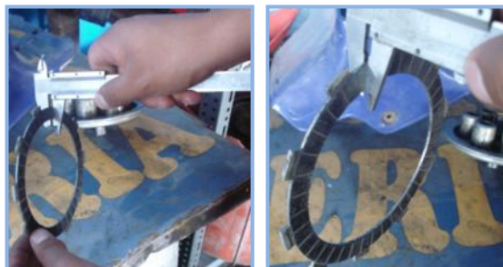
FIGURA 3.23 Medición de Discos de Fricción.
