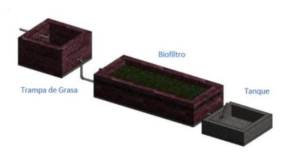
Nota. La ilustración muestra un esquema de la trampa de grasa.
