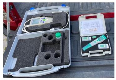
*Nota.* La imagen muestra los equipos que se utilizaron para medir los parámetros de pH, conductividad eléctrica y temperatura.
