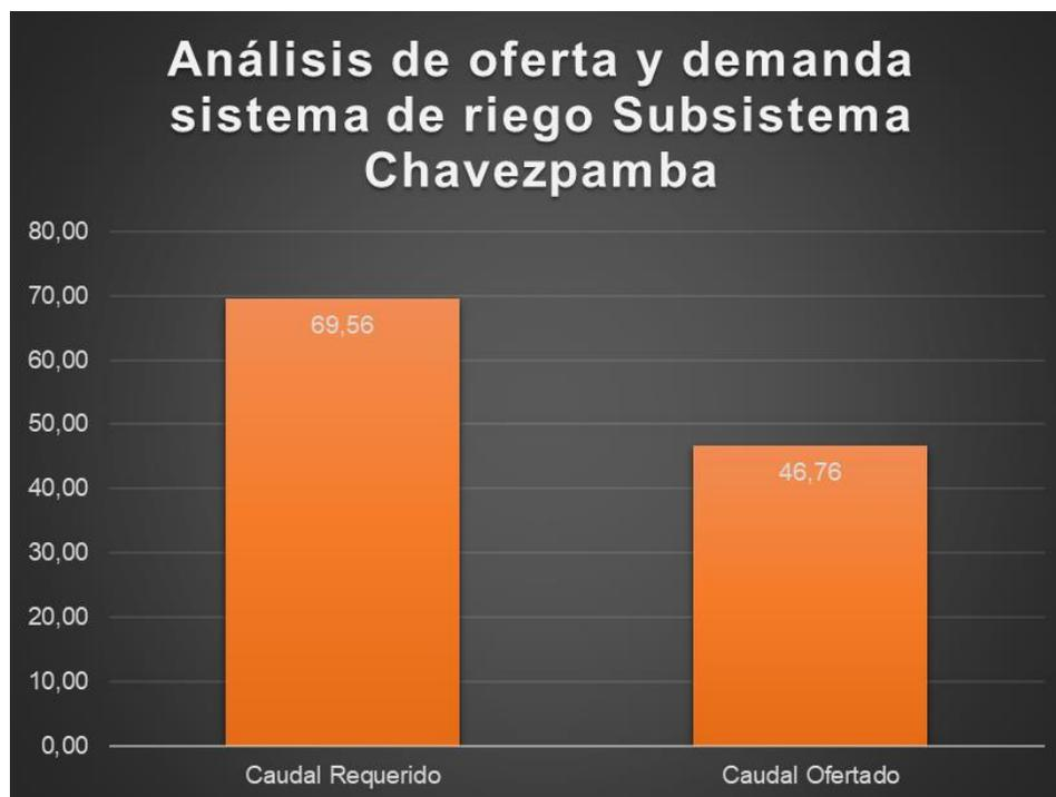
*Nota.* El gráfico representa la distribución los caudales ofertado y requerido del sistema de riego Subsistema Chavezpamba.
