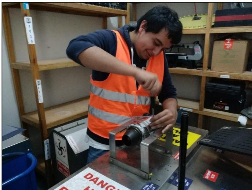
**Figura 49 Montaje provisional del motor al banco de pruebas**
