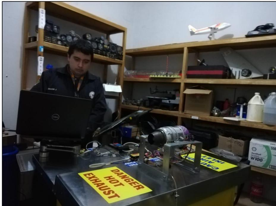
**Figura 80 Prueba de los Sistemas del Motor JETCAT**
