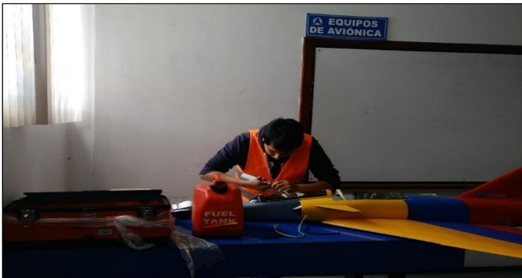
**Figura 44 Desconexión del cableado eléctrico del motor JETCAT**
