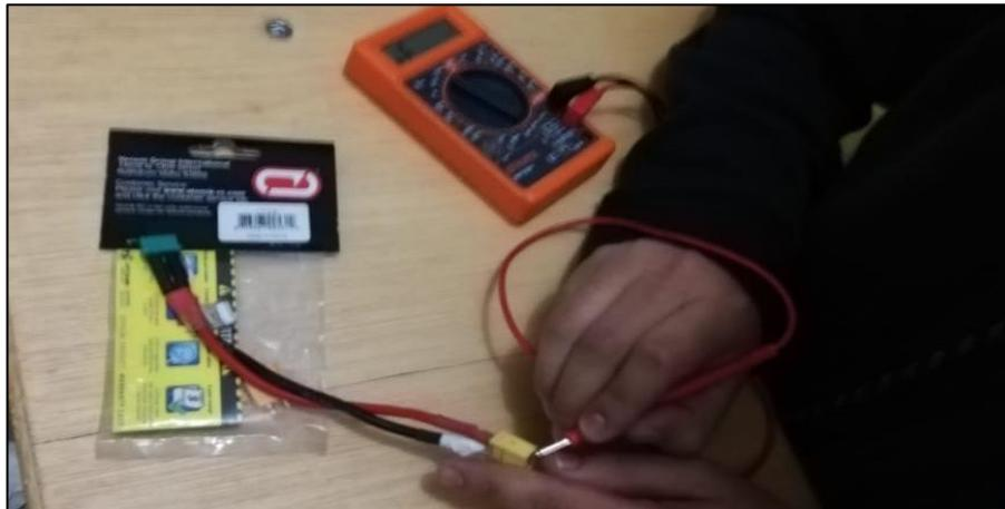
**Figura 52 Verificación de continuidad a los cables de alimentación eléctrica**
