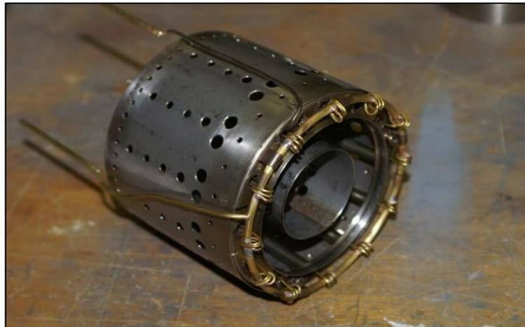
**Figura 21 Sección de Combustión motor JETCAT**
