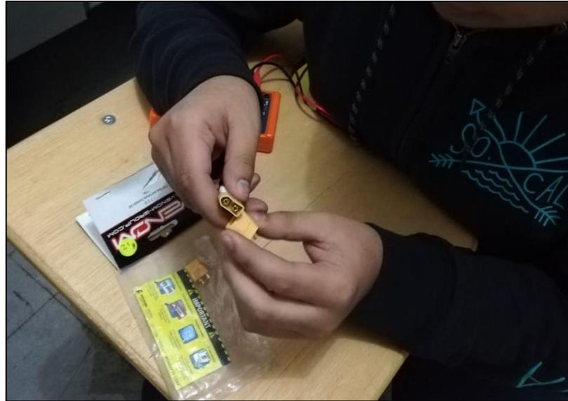
**Figura 54 Reemplazo del conector XT60**
