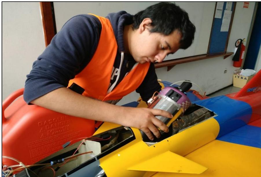
**Figura 48 Desmontaje del motor JETCAT del avión a R/C Cheetah**
