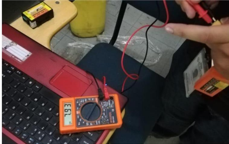
**Figura 68 Chequeo del voltaje de la batería LIPO**
