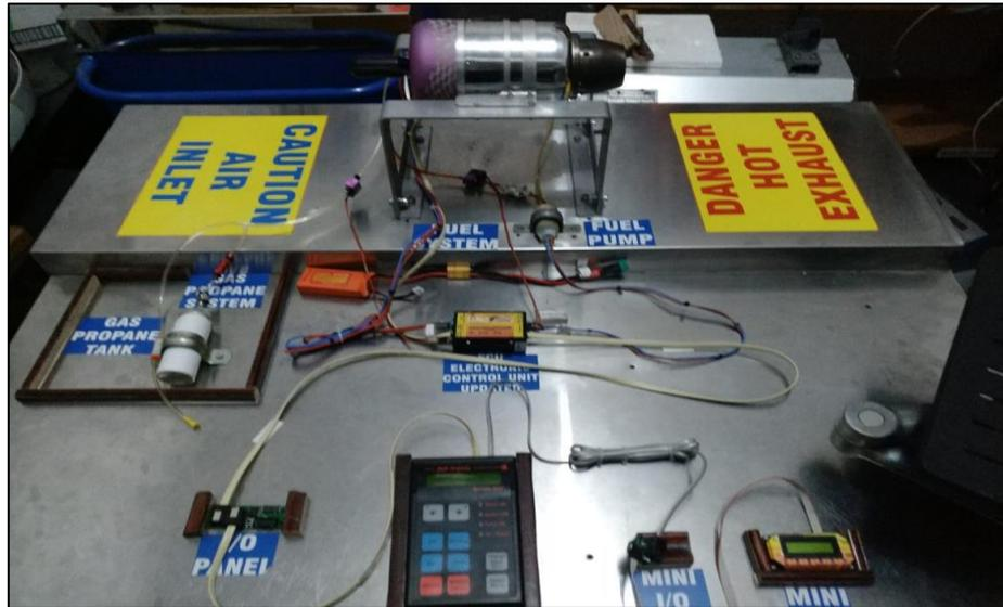
**Figura 79 Vista Frontal Banco de Pruebas con los componentes**
