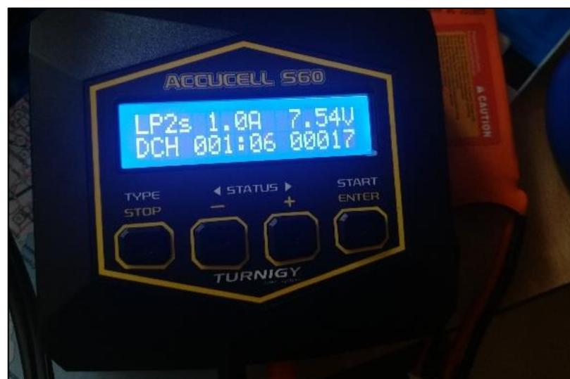
**Figura 56 Proceso de descarga batería LIPO**
