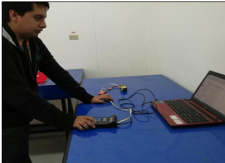
**Figura 69 Conexión del adaptador RS232 a la computadora**
