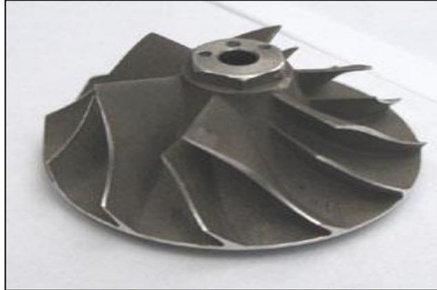
**Figura 20 Sección de Compresión motor JETCAT**
