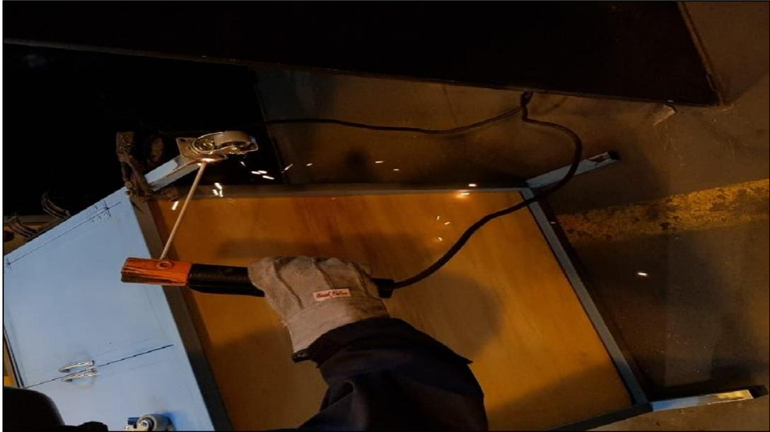
**Figura 41 Anclaje de ruedas al banco de pruebas**
