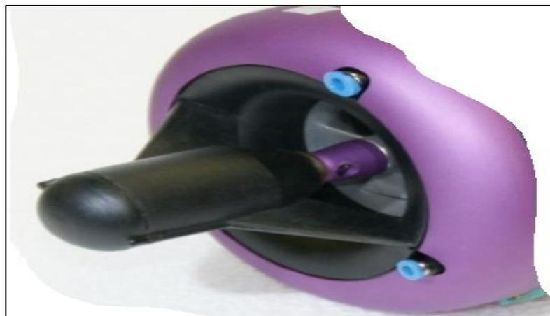
**Figura 19 Sección de Admisión motor JETCAT**
