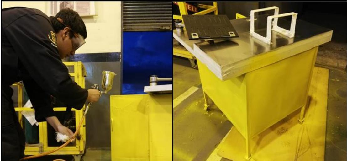
**Figura 43 Pintado de la Estructura y su acabado final**
