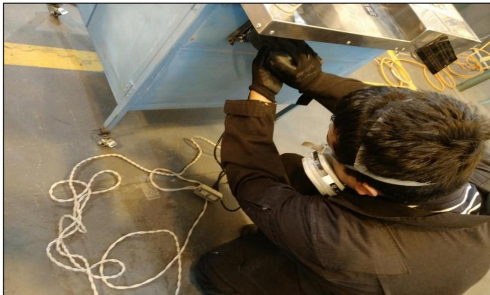
**Figura 42 Lijado de la Estructura**
