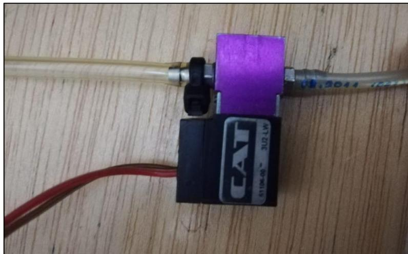
**Figura 61 Revisión de la valvula de control de gas**
