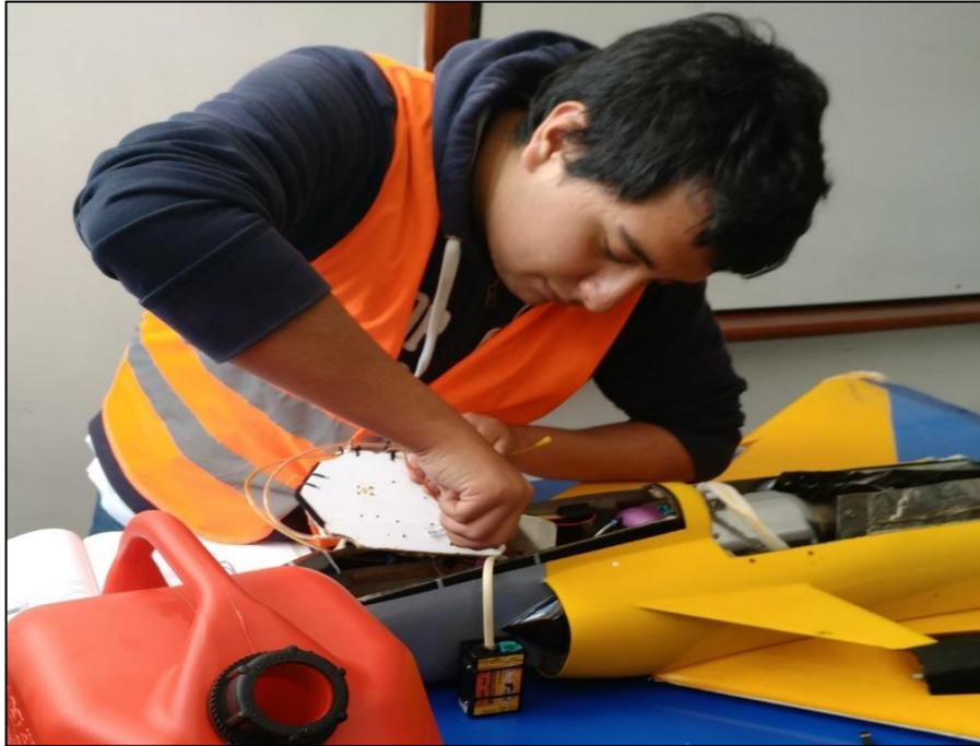
**Figura 47 Desconexión del ECU del motor JETCAT**
