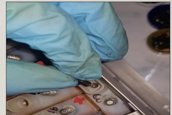
Extracción de las válvulas de ventilación
