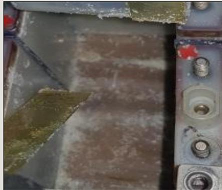
Presencia de fuga de electrolito en la caja de la batería
