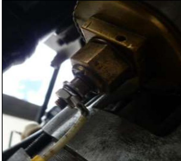
**Figura 37** Transmisor tipo termómetro.
