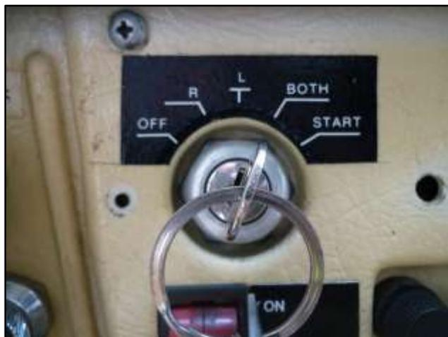
Figura 27 Switch de encendido.
