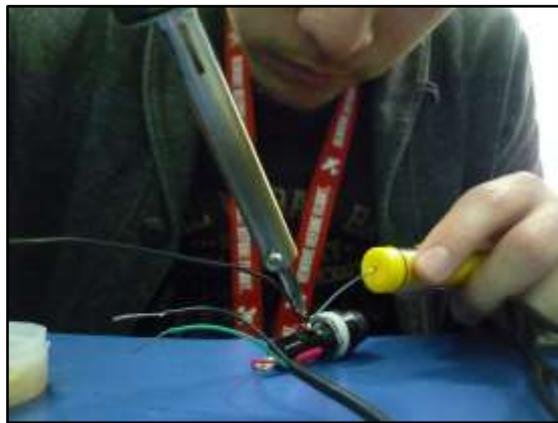
**Figura 35** Soldado de la conexión.
