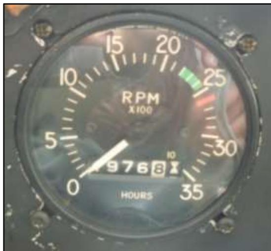
**Figura 21** Tacómetro C150.
