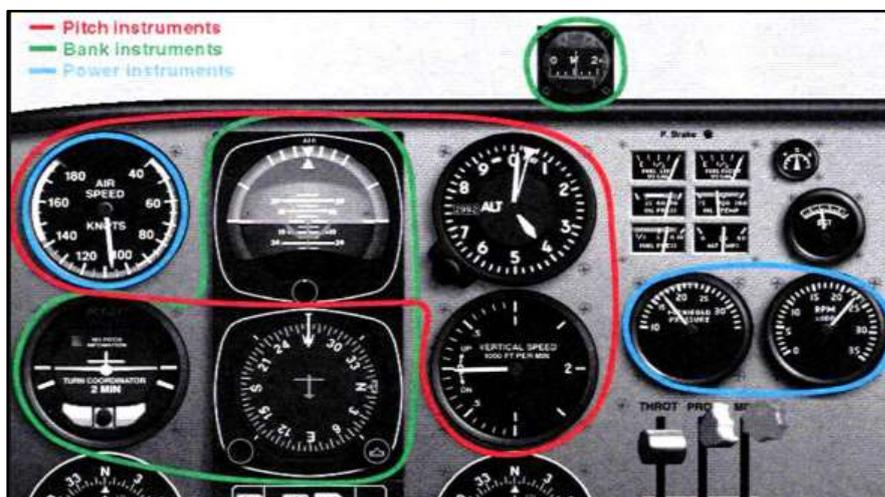
**Figura 6** Clasificación de los instrumentos.
