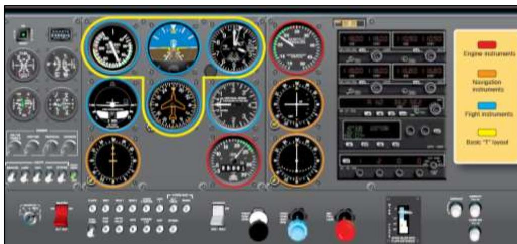
**Figura 3** Panel Principal – Instrumentos Analógicos.
