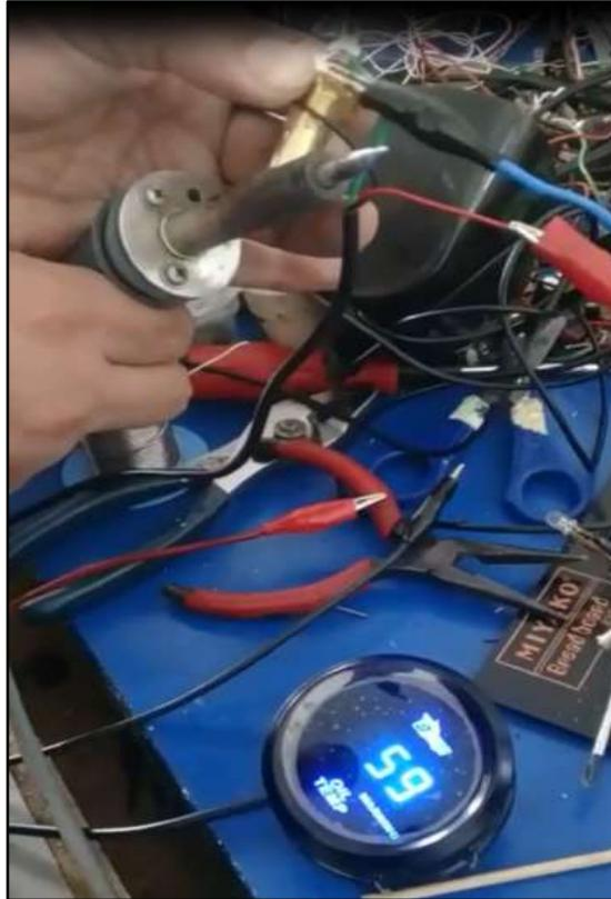
**Figura 43** Simulación de prueba de temperatura con cautin.
