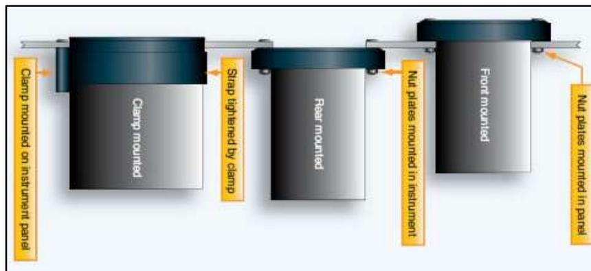
**Figura 25** Montaje de los instrumentos.
