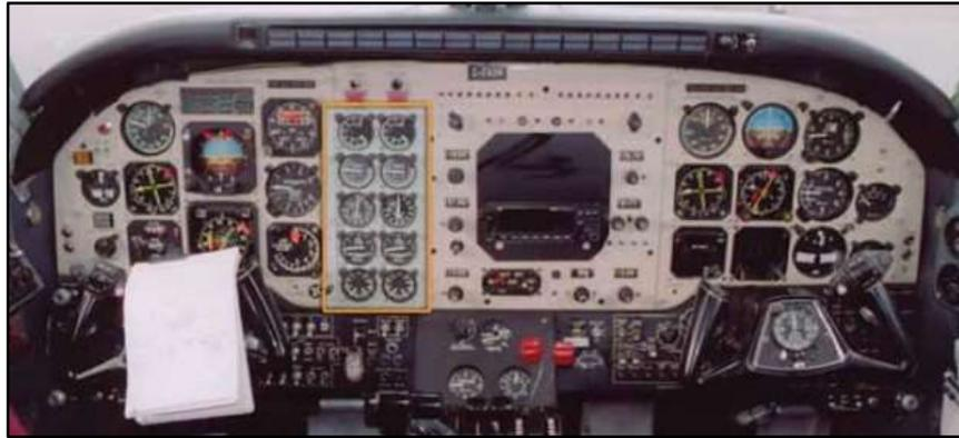
**Figura 10** Instrumentos del motor.
