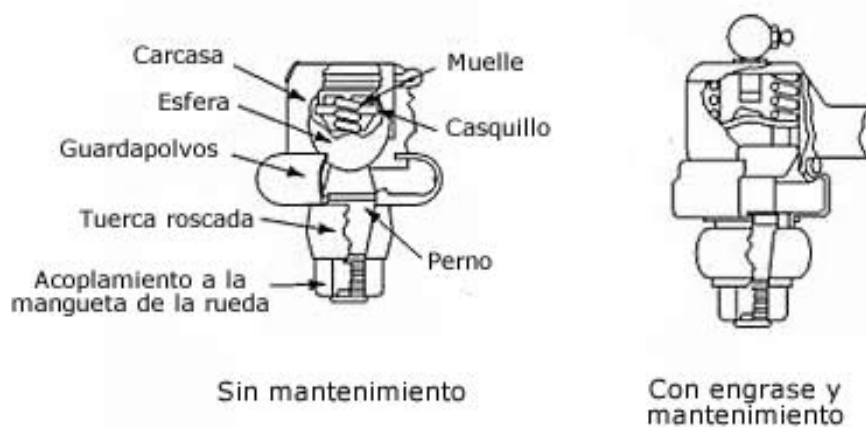
Figura 1.4. Esquema interno de las rótulas de dirección
