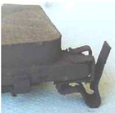
Figura 1.50. Sensor de desgaste de la pastilla de freno
