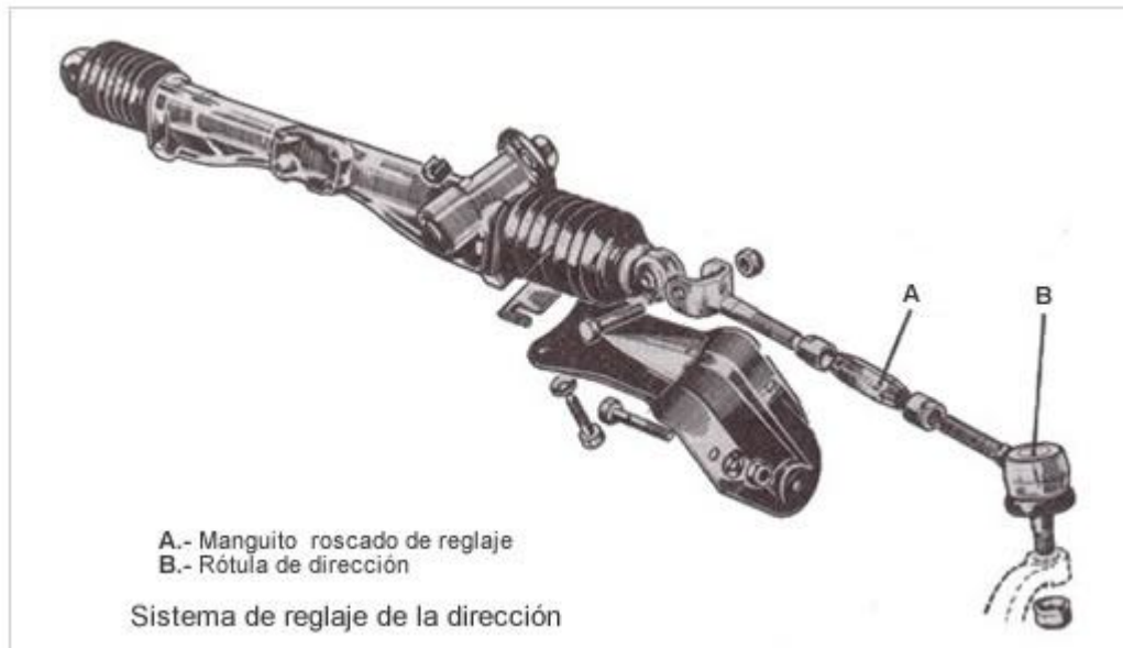
Figura 1.69. Sistema de reglaje de la dirección por cremallera
