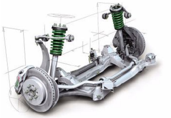
Figura 1.28. Tren delantero del S – Type equipado con el sistema CATS
