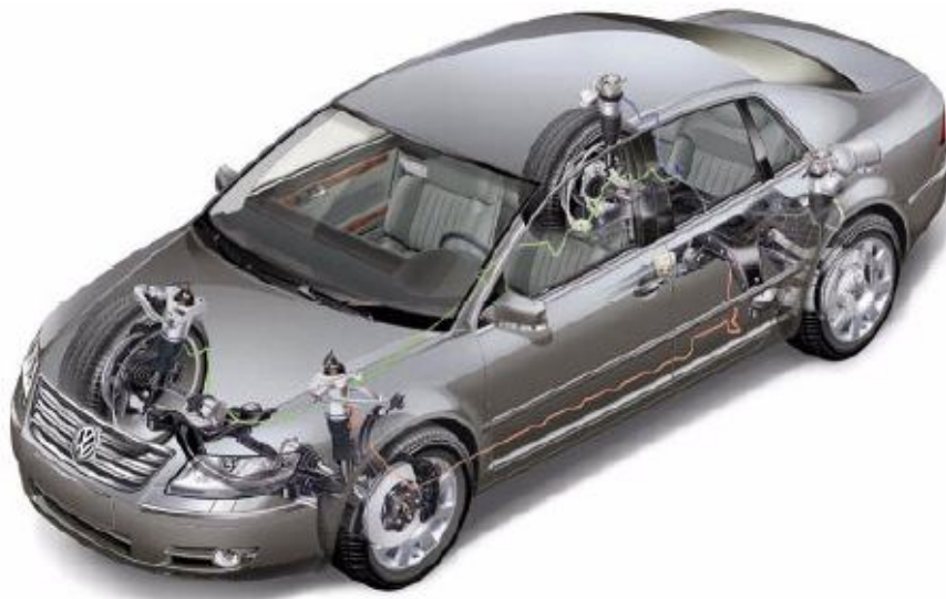
Figura 1.25.Elementos del sistema de suspensión neumática del VW Phaeton
