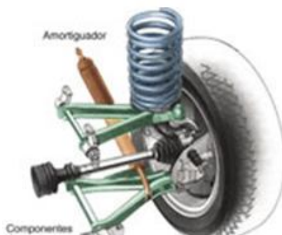
Figura 1. 2. Conjunto amortiguador y resorte
