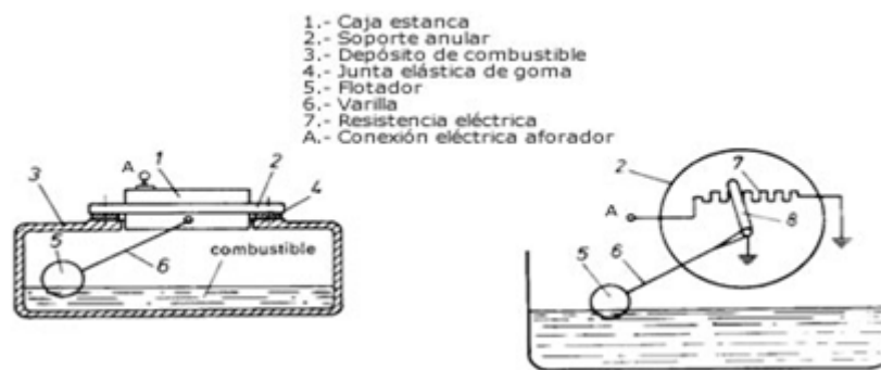
Figura 5.20. Funcionamiento interno del indicador de combustible
