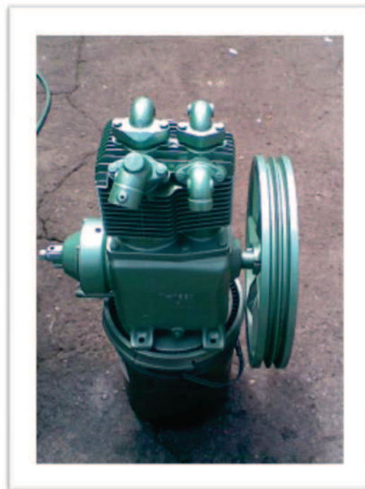
Foto 3.20 Cabezal del compresor en proceso de pintura
