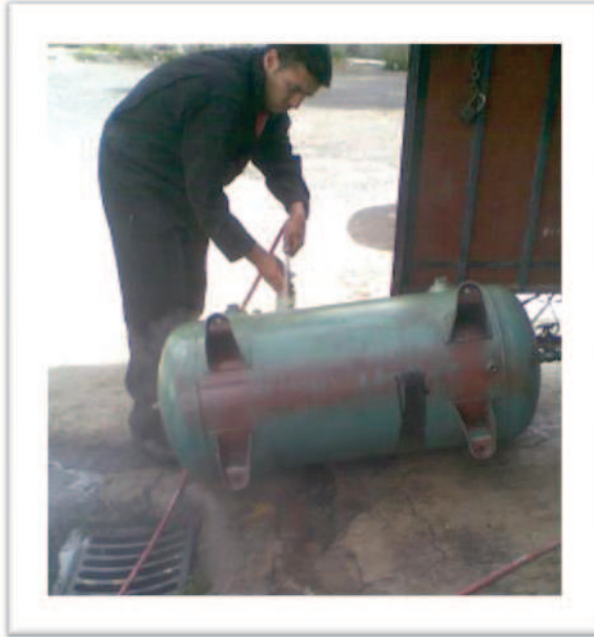
Foto 3.12 Limpieza externa del tanque del compresor Fuente: Taller de Mecánica Básica Realizado por: Xavier Obando
