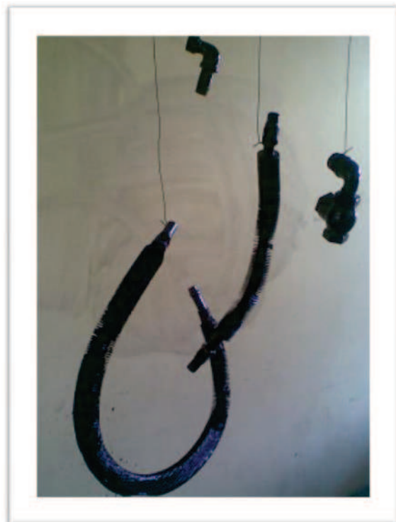
Foto 3.22 Pintura de cañerías
