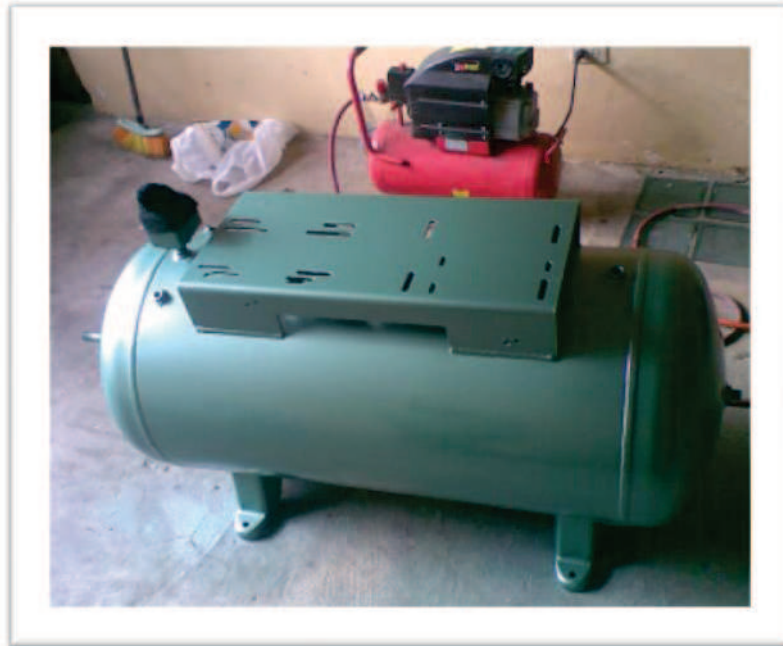
Foto 3.19 Tanque en proceso de pintura
