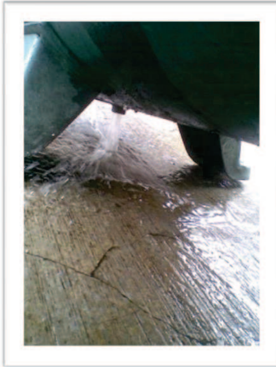
Foto 3.10 Limpieza interna del tanque del compresor Fuente: Taller de Mecánica Básica Realizado por: Xavier Obando
