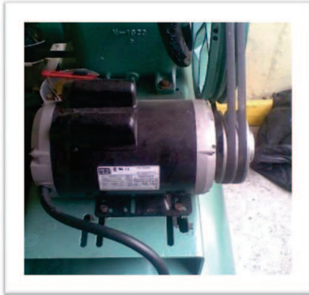
Foto 3.30 Instalación de las bandas
