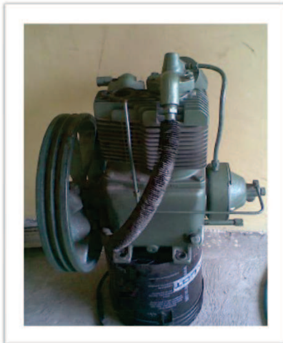
Foto 3.4 Situación actual del cabezal del compresor
