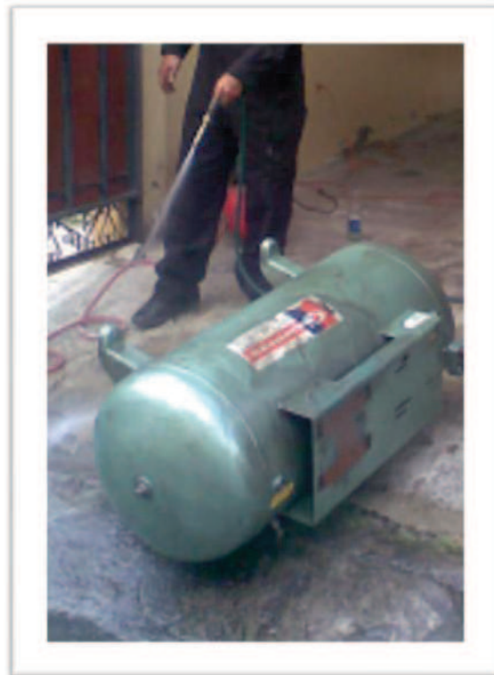
Foto 3.11 Limpieza externa del tanque del compresor Fuente: Taller de Mecánica Básica Realizado por: Xavier Obando
