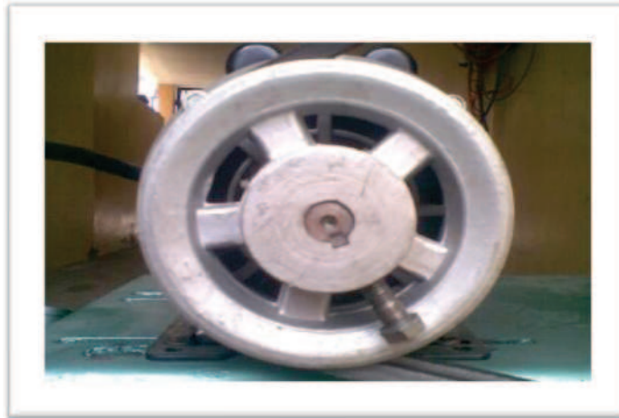
Foto 3.28 Instalación de la polea en motor
