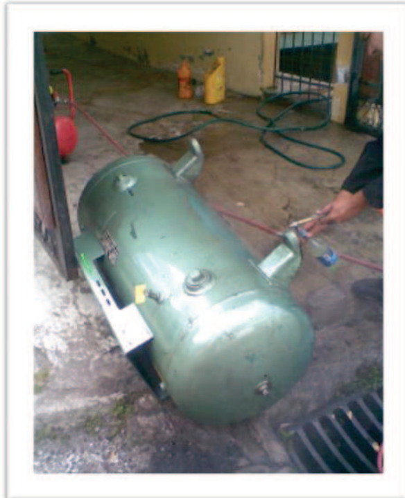
Foto 3.13 Limpieza externa del tanque del compresor Fuente: Taller de Mecánica Básica Realizado por: Xavier Obando
