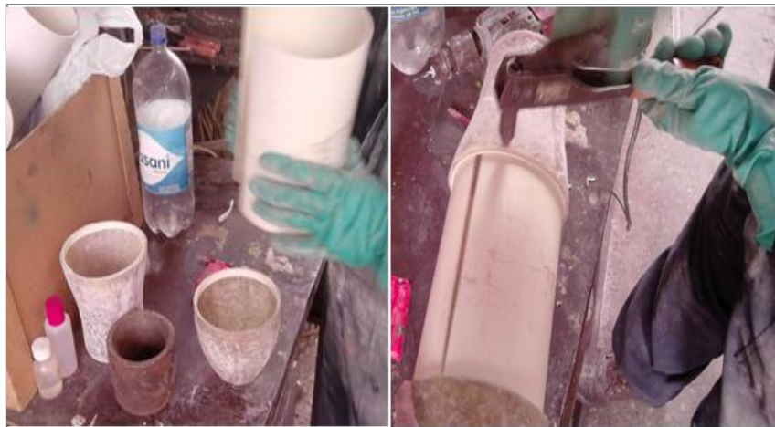
Figura 3.13 Ensamblado de secciones
