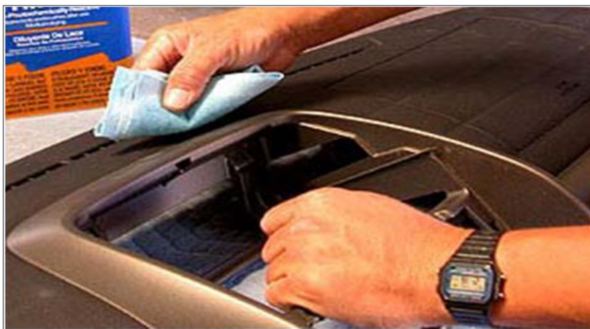
Figura 3.3 Preparación de la superficie
