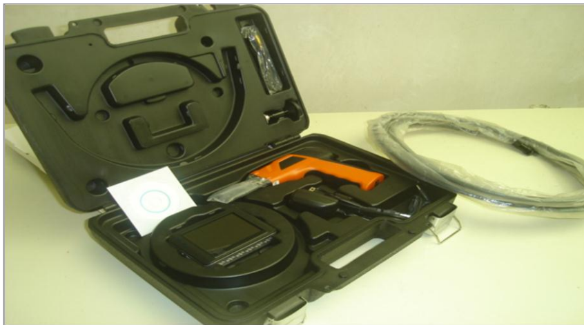
Figura 2.1 Equipo de inspección visual remota
