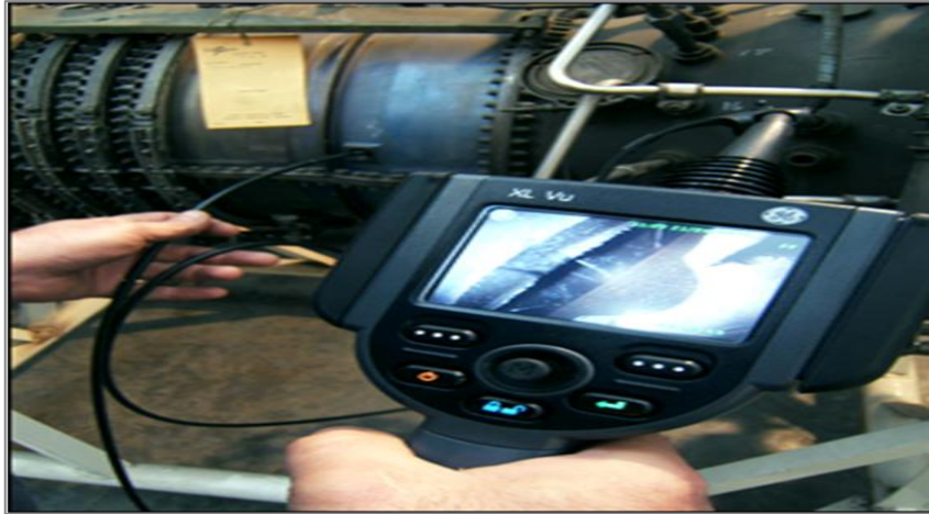
Figura 2.12 Inspección remota a un motor turbo fan.
