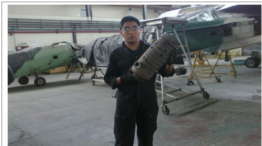
Figura2.2 Desmontaje de cámara de combustión motor JT-8D
