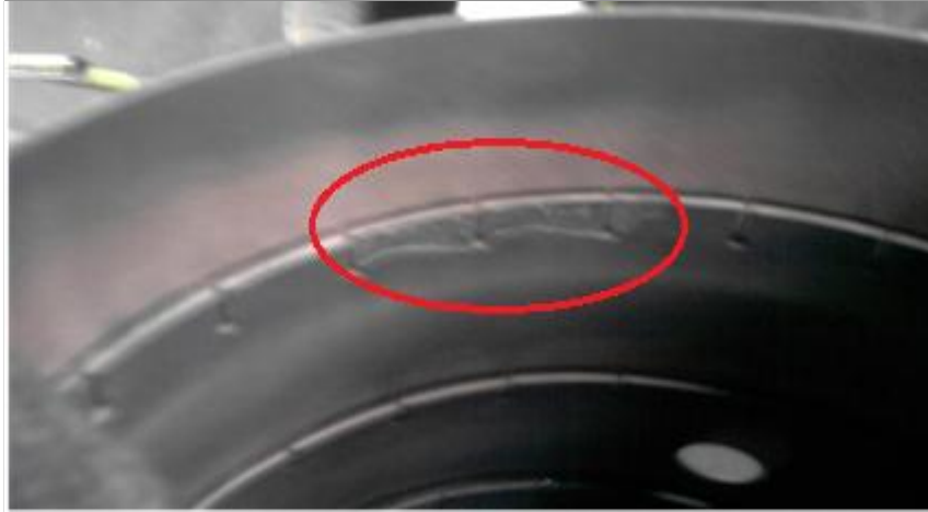
Figura 2.19 Desprendimiento de cerámica
