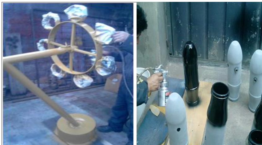
Figura 3.17 Proceso de pintura
