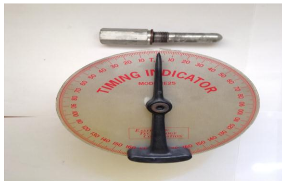
Figura 3.48. Instrumento para localizar grados para el timing
