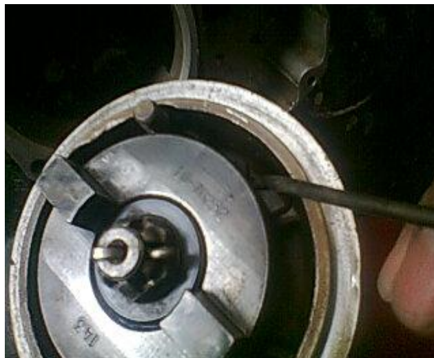
Figura 3.22. Inspección conjunto de impulsor
