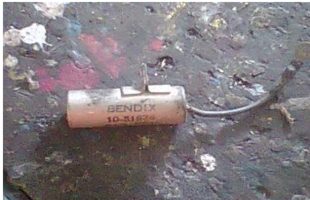
Figura 3.27. Identificación del condensador
