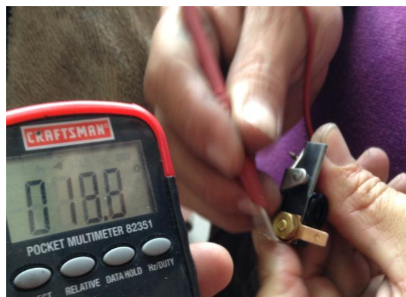
Figura 3.13. Inspección de los contactos del platino
