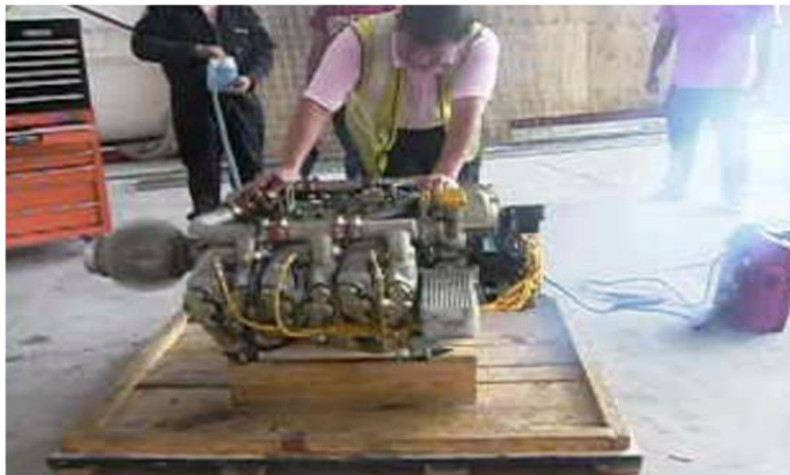
Figura 3.50. Encendido del motor TC IO 360 D
