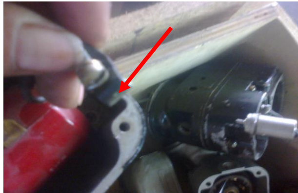
Figura 3.20. Inspección de las abrazaderas de la bobina
