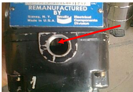
Figura 3.38. Orificio de visualización de marca en el engrane del rotor
