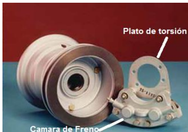
Figura 2.7: Freno de disco fijo.
