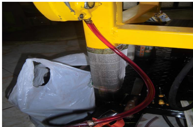
Figura 3.19: Abastecimiento de líquido hidráulico. Fuente: Investigación de Campo.
