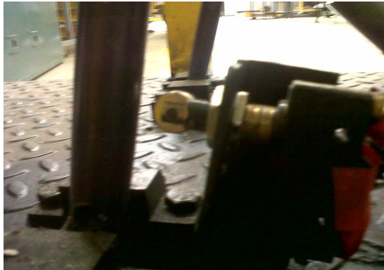
Figura 3.13: Pulsador normalmente cerrado. Fuente: Investigación de Campo.
