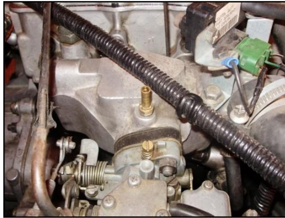
Figura 4.4 Toma de vacío en el múltiple de admisión
