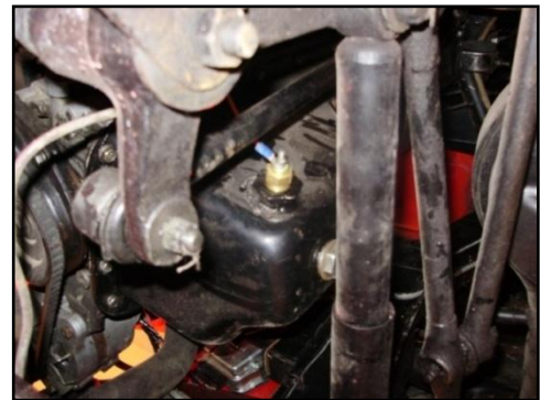
Figura 4 Sensor de temperatura de aceite instalado en el cárter
