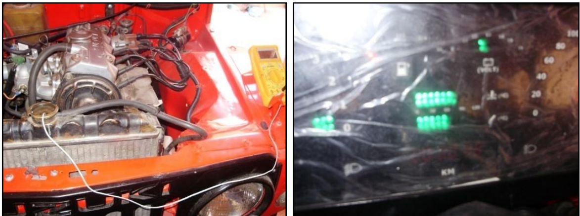
Figura 4.1 Pruebas del sensor de temperatura de refrigerante
