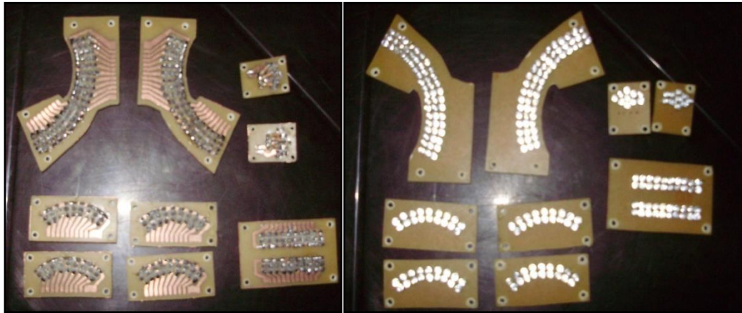
Figura 3.21 Tarjetas electrónicas de luces de tablero
