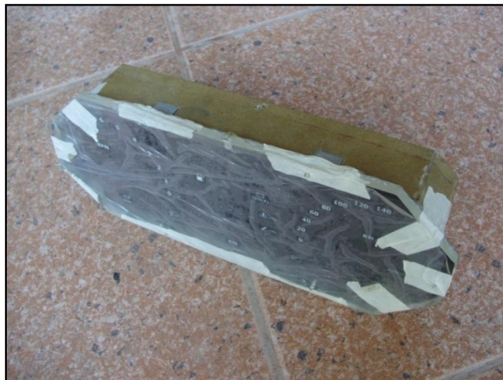
Figura 3.11 Tablero de instrumentos antes de ser instalado
