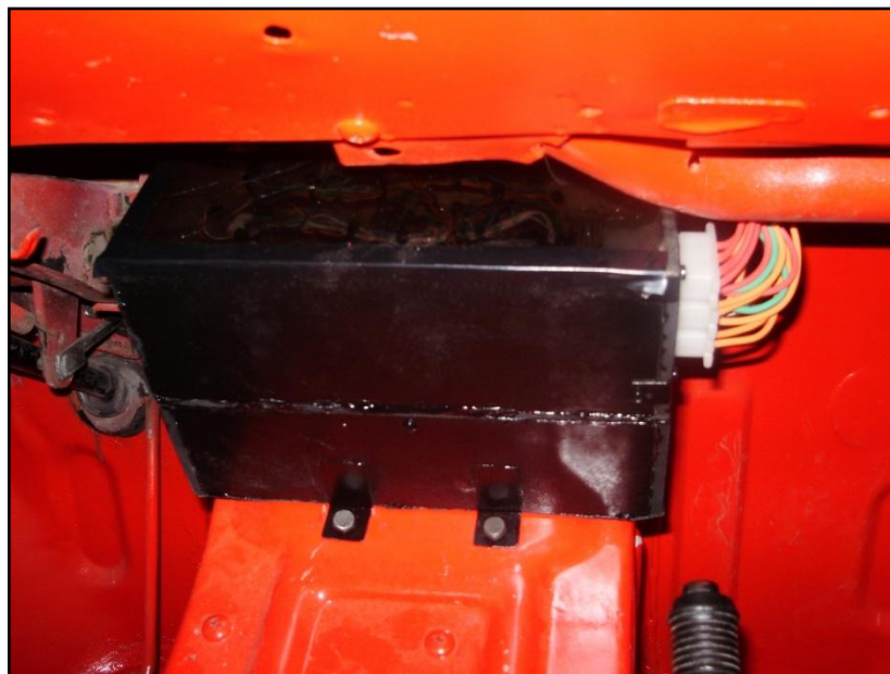
Figura 3.10 Caja de control electrónico
