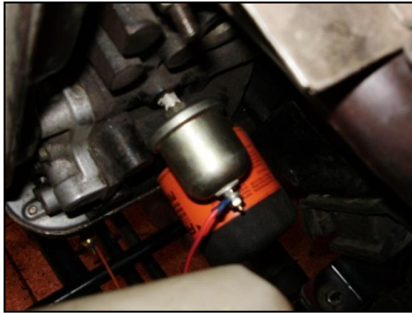
Figura 3.9 Sensor de presión de aceite instalado
