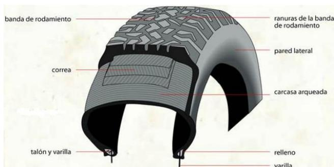
*Nota.* La estructura del neumático la constituyen diferentes componentes. Tomado de (Dery, 2020).
