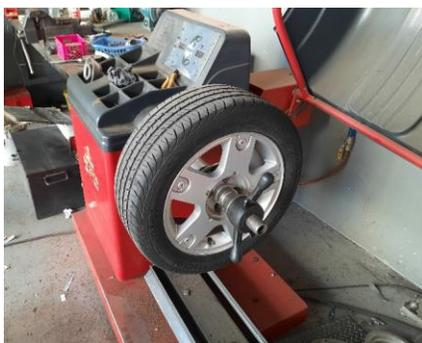
Para la rueda especificada se colocó un contrapeso de 60 gramos en la posición exterior. Concluido el proceso de balanceo se vuelve a colocar en el vehículo.
