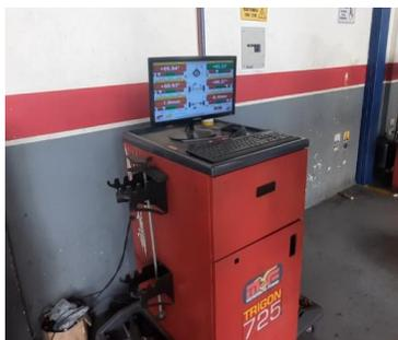
Se procede a colocar al vehículo en el elevador y se ajustan las agarraderas con los sensores para la alineación.
