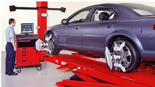
*Nota.* El gráfico representa el equipo necesario para la alineación de las ruedas. Tomado de *¿Cómo puedo saber si mi coche necesita una alineación?* [Fotografía], por López, D., 2011, (<https://www.actualidadmotor.com/como-puedo-saber-si-mi-coche-necesita-una-alineacion/>).
