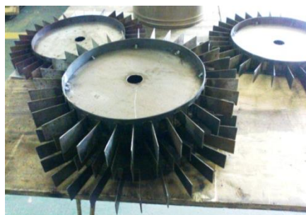
Figura 3.23: Perforación 1 5/8" para el bocín
