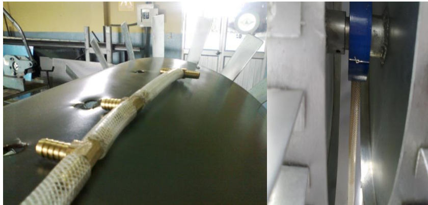
Figura 3.45: Distribución del aceite a los cojinetes
