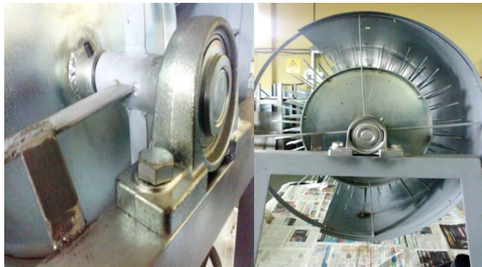
Figura 3.36: Fijación del recubrimiento exterior
