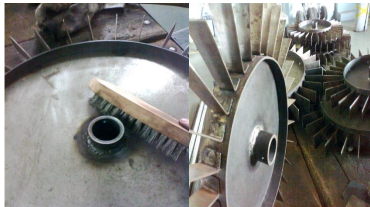
Figura 3.25: Limpieza de la soldadura
