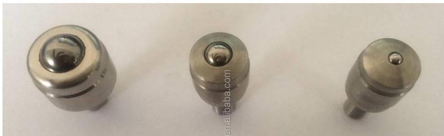
*Nota.* Indentadores empleados en el ensayo Brinell. Tomado de Rockwell indentador de bolas.
