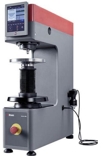
*Nota.* Durómetro empleado para ensayos de dureza. Tomado de Durómetro Brinell resistente y fiable
