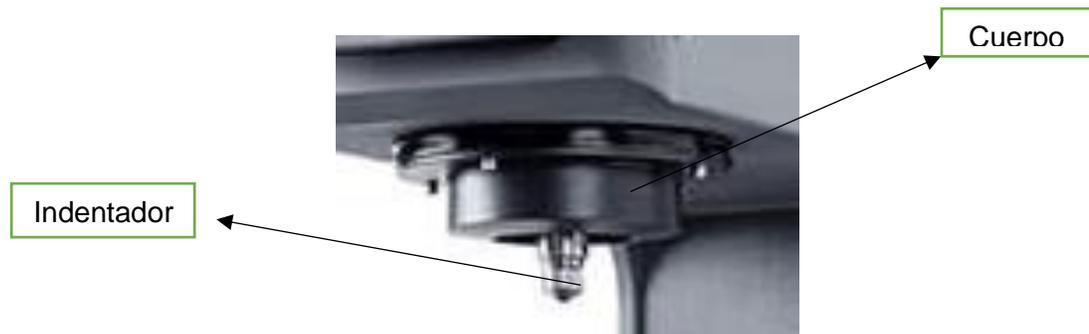
*Nota.* Partes principales que interfieren en el ensayo de dureza. Tomado de Durómetro Brinell resistente y fiable
