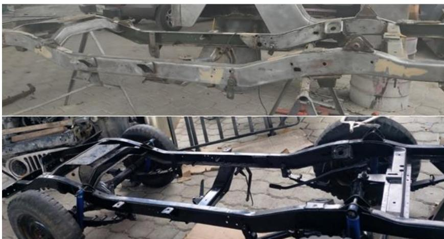
*Nota.* En la parte posterior de la figura se muestra el chasis en proceso de reconstrucción y en la parte inferior se muestra el trabajo final del chasis, donde se evidencia la eliminación de deformaciones y óxido por sus alrededores.
