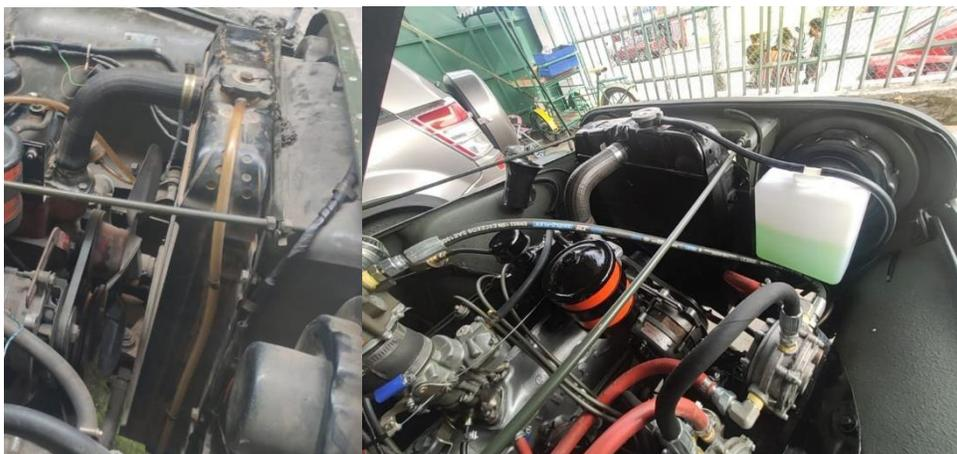
*Nota.* Se visualiza en la parte izquierda el estado deteriorado del sistema de refrigeración conjuntamente con sus partes incompletas mientras que en la parte derecha se visualiza el trabajo de restauración y puesta a punto del sistema.
