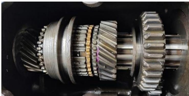
*Nota.* Se visualiza el mantenimiento correctivo del eje primario de caja de velocidades, donde se reemplazó el conjunto de engranajes y sincronizadores en mal estado.
