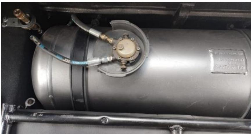
*Nota.* En la figura se visualiza la instalación del reservorio de GLP por medio de bandas en sus extremos y con la habitación del acople rápido para su reposición de combustible GLP.
