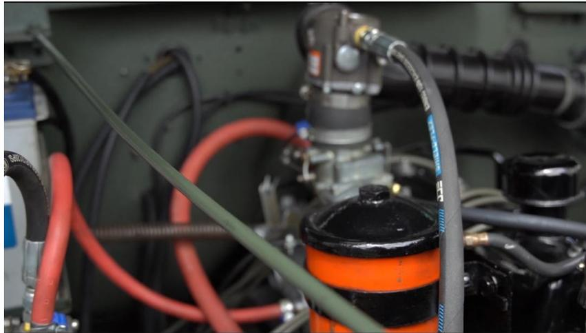
*Nota.* En la imagen se visualiza la instalación de cañerías de baja, alta presión y conexiones de vacío tomadas del múltiple de admisión hacia el filtro de GLP.
