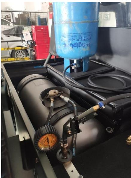
*Nota.* En la figura se observa la conexión con el kit de trasvase entre el depósito de remanso y el depósito del vehículo para poder recuperar el combustible consumido.
