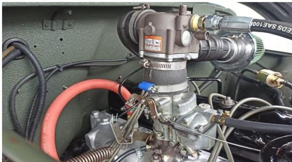
*Nota.* En la imagen se visualiza la instalación del evaporador de GLP entre el múltiple de admisión y el carburador del vehículo con su respectiva conexión proveniente del evaporador.
