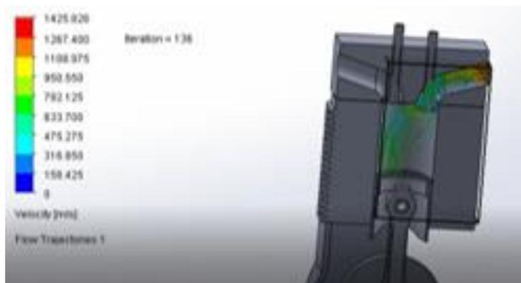
*Nota.* En la imagen se muestra el flujo de carburante ingresando a la cámara de combustión.
