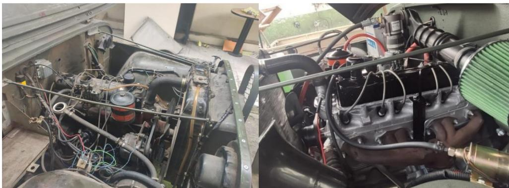
*Nota.* Se visualiza el trabajo de restauración realizado en el motor BF – 161 del vehículo Jeep Willys CJ3A, manteniendo su originalidad como autoparte de reliquia y dejándolo en condiciones ideales para la implementación y funcionamiento del sistema BI-FUEL.
