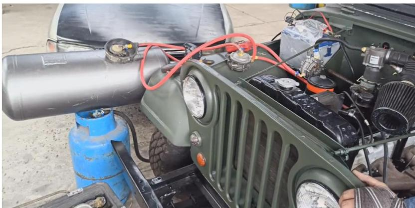
*Nota.* En la imagen se visualiza los todos los componentes del kit de tercera generación en una prueba de funcionamiento utilizando GLP como carburante.
