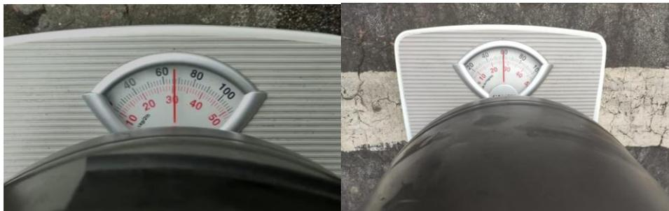
*Nota.* En la sección izquierda la balanza indica un valor de 30 kg de GLP antes de utilizarlo en el vehículo, y en la sección derecha se observa un peso de 27 kg.
