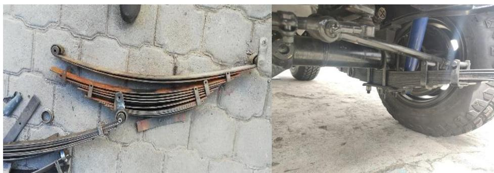
*Nota.* Se puede observar el sistema de suspensión en el estado en el que se encontraba y posteriormente el mantenimiento correctivo aplicado a al sistema de ballestas y el reemplazo de amortiguadores.
