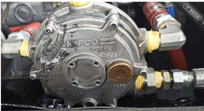
*Nota.* En la imagen se visualiza la instalación del evaporador - reductor de GLP por medio de pernos sujetado a la carrocería del vehículo y sus conductos de refrigeración de color rosado ubicado en los laterales.
