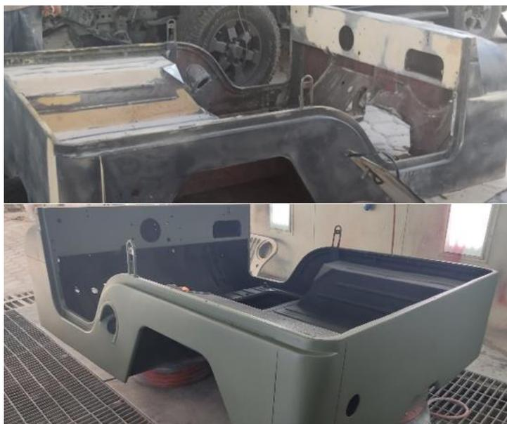
*Nota.* En la imagen superior se visualiza el proceso de restauración de la carrocería mientras que en la imagen inferior se visualiza la reparación total de la carrocería manteniendo la originalidad.
