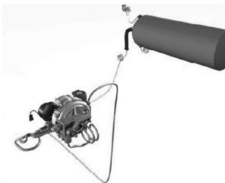
*Nota.* En la imagen se muestra el circuito de alta presión de GLP donde se visualiza el reservorio, electroválvula, filtro de GLP, evaporador – reductor, y cañerías. Tomado de Rodés. (28 de 09 de 2015). Motores a GLP y GNC.
