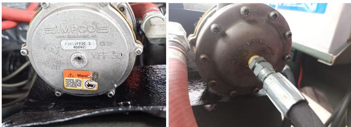
*Nota.* En la imagen se visualiza la instalación del filtro de GLP por medio de pernos sujetado a la carrocería del vehículo.
