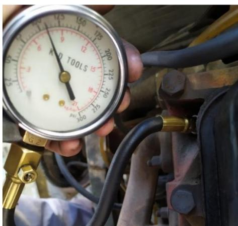
*Nota.* Se presenta en la figura un medidor de presión con una escala en PSI en ella se demuestra la medición en el cilindro 1 donde se evidencia que se encuentra en un valor de 110 PSI.
