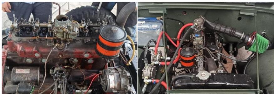
*Nota.* Se evidencia en la parte izquierda el estado deteriorado producto de la falta de mantenimiento preventivo y parte derecha se visualiza el mantenimiento correctivo total del sistema de lubricación del motor de combustión interna.
