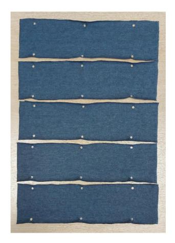
Este ensayo considera todos los parámetros que la norma ISO 3795 indica, incluido el acondicionamiento modificado que se puede hacer con el equipo disponible
