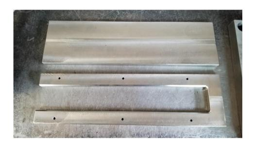
*Nota*. En la figura se observa las platinas soldadas, antes y después de las operaciones de mecanizado.
