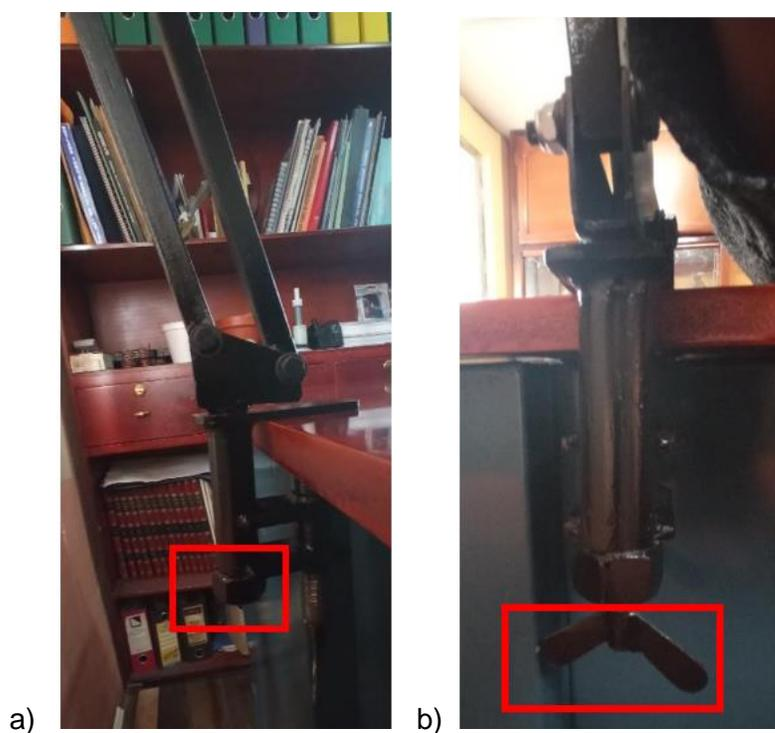
*Nota.* a) Tuerca de ajuste de la rotación de la estructura b) Mariposa de ajuste de la prensa de anclaje de la estructura
