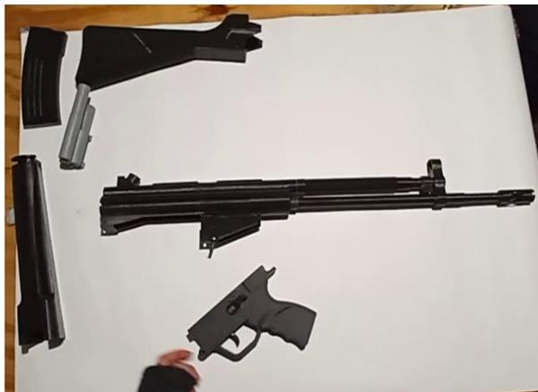
La varilla de recuperación está compuesta por un tubo de aluminio de diámetro externo de 8mm e interno de 6mm, por lo cual únicamente se imprimió los anillos y tapas del tubo, esto se puede ver en la Figura 50. Además, para que la estética de esta pieza sea igual a la pieza original se usó también un resorte con un alambre de 0.8 mm y 75 vueltas para una longitud de 27 cm.
