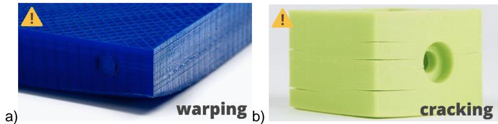
*Nota.* a) Problema de warping en una pieza impresa en 3D b) problema de cracking en una pieza impresa en 3D. Tomada de (Bitfab, s.f.)
