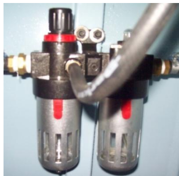
Fig. 5.11. Ubicación de la unidad de mantenimiento
