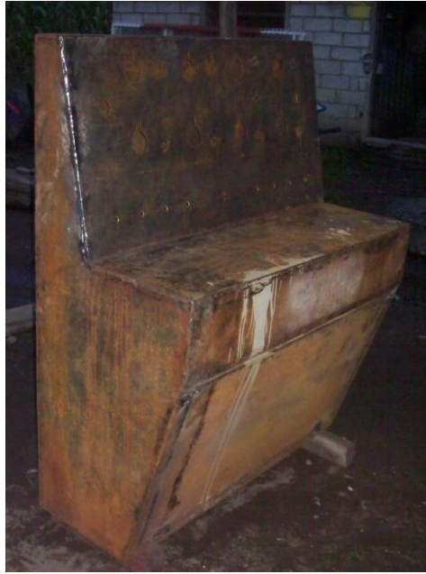
Fig. 5.5. Fijación del panel principal a la estructura
