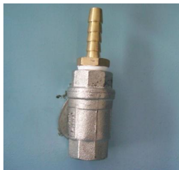
Fig. 5.8. Uniones roscadas selladas mediante teflón
