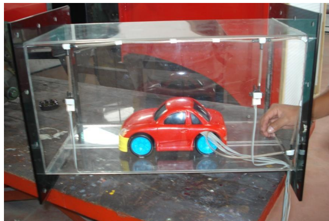
Figura 4. 45 Fijación de sensores que miden la velocidad de entrada y salida, cables listos para ser conectados
