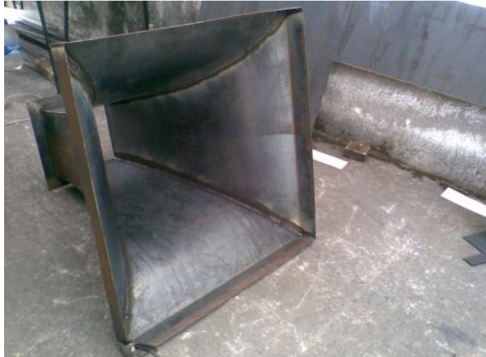
Figura 4. 5 Ensamble de la zona de contracción
