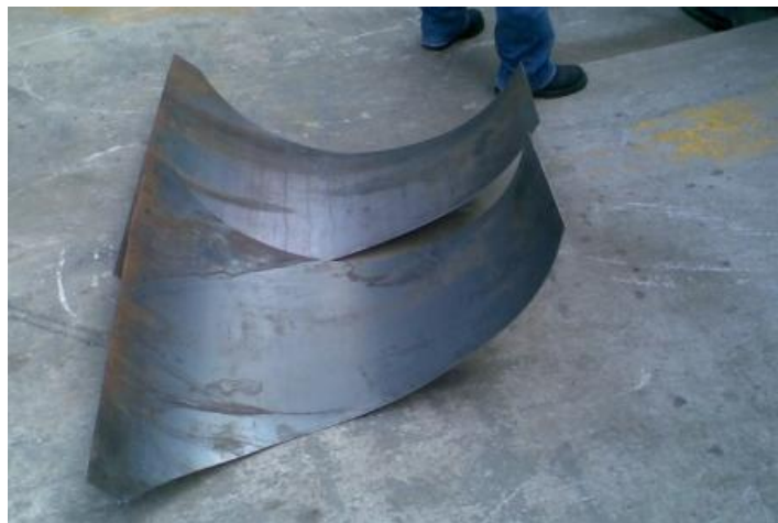
Figura 4. 4 Rolado de caras de la zona de contracción
