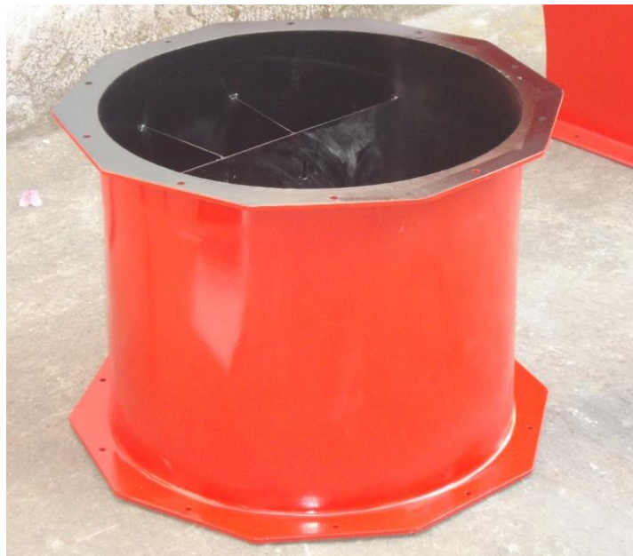
Figura 4. 17 Acabado y pintado de la zona de impulsora
