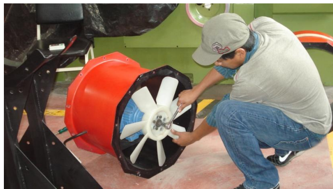
Figura 4. 35 Sujeción del ventilador al motor eléctrico
