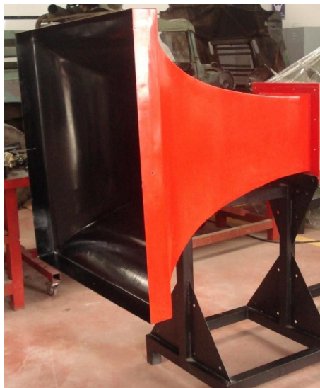
Figura 4. 31 Sujeción del cono de contracción
