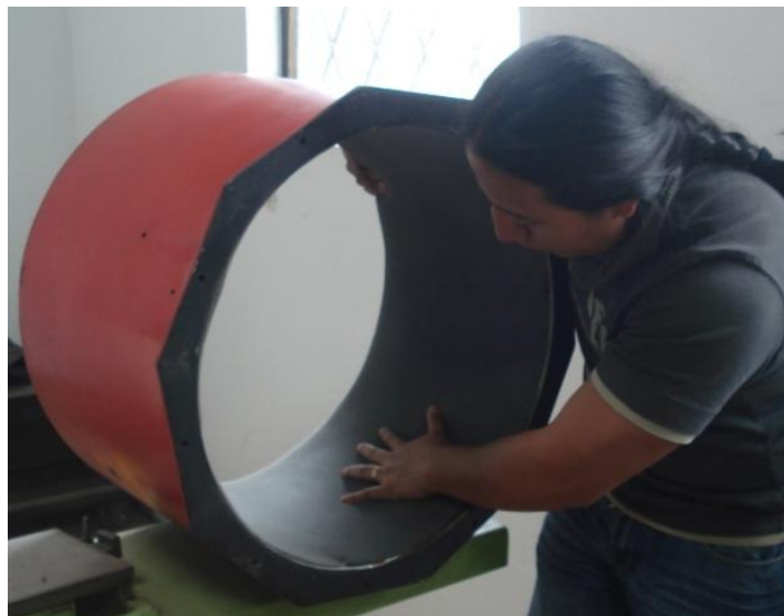
Figura 4. 19 Terminado el silenciador y pegando de esponja para ruidos
