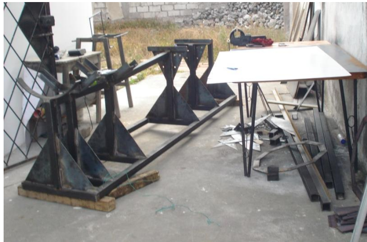
Figura 4. 1 Construcción de la Bancada
