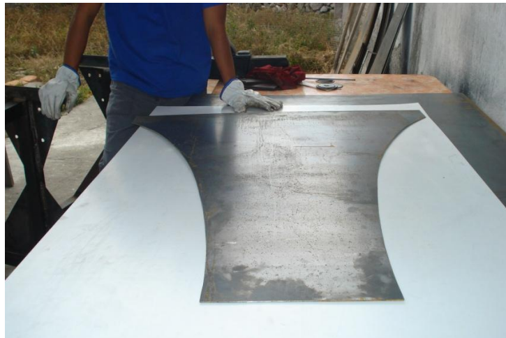
Figura 4. 3 Cara del cono de la zona de contracción
