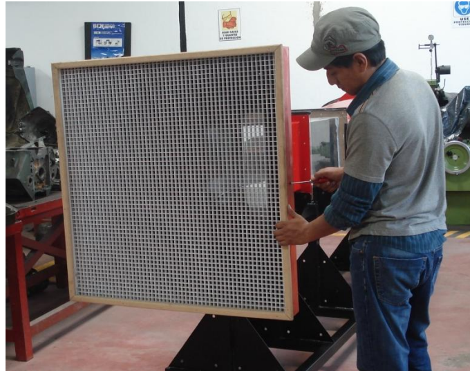
Figura 4. 32 Sujeción del panel de abejas
