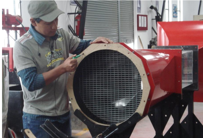
Figura 4. 34 Sujeción de la zona de seguridad al difusor y bancada
