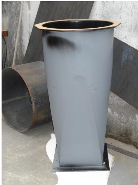
Figura 4. 10 Ensamble de marcos y caras del difusor
