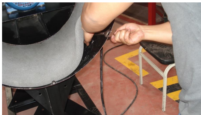
Figura 4. 41 Adhiriendo esponja en el silenciador
