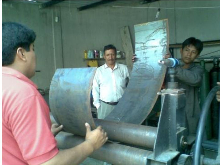
Figura 4. 18 Rolado del silenciador
