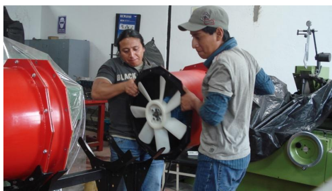
Figura 4. 38 Ubicando la zona impulsora
