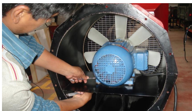
Figura 4. 37 Fijado y centrado conjunto hélice - motor en zona impulsora
