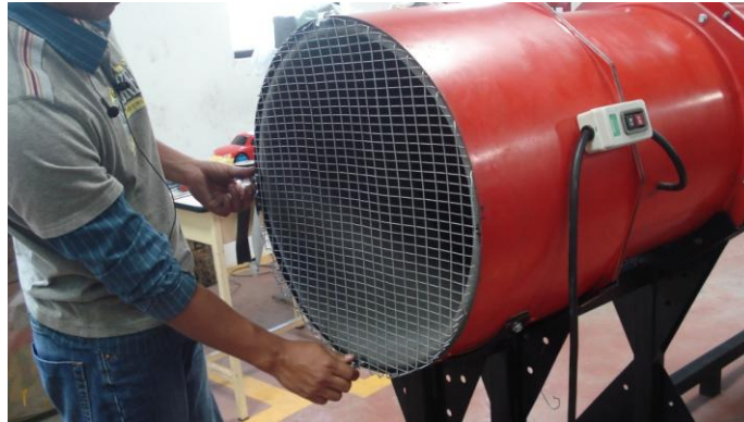
Figura 4. 42 Colocando la malla en el silenciador
