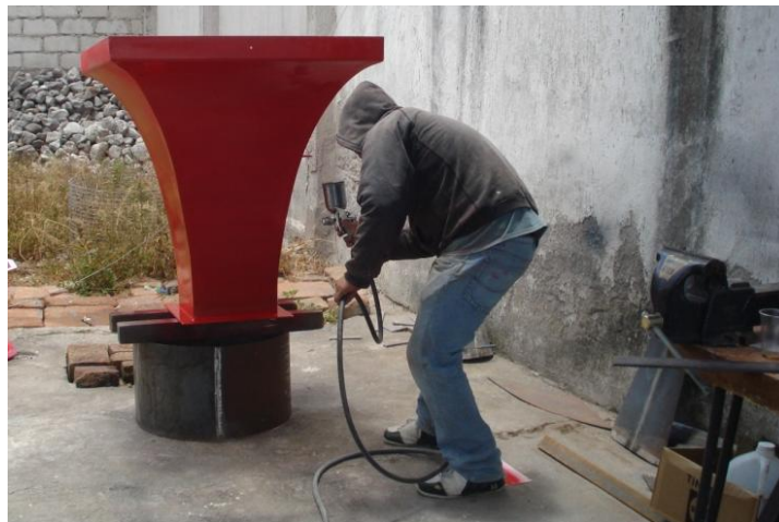
Figura 4. 6 Acabado y pintado de la zona de contracción
