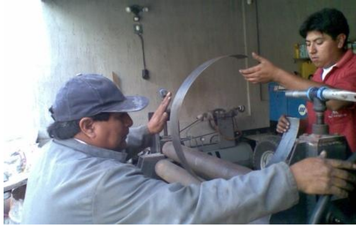
Figura 4. 13 Rolado de la zona de seguridad
