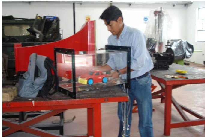
Figura 4. 44 Vehículo de prueba fijado y centrado en la zona de prueba
