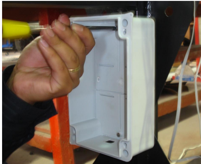
Figura 4. 46 Fijación de caja contenedora de la placa y de NI USB 6009
