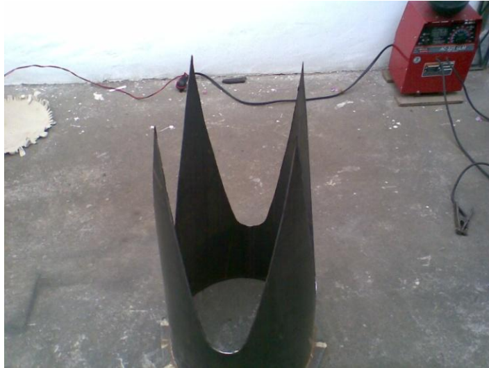
Figura 4. 9 Cortes en el difusor
