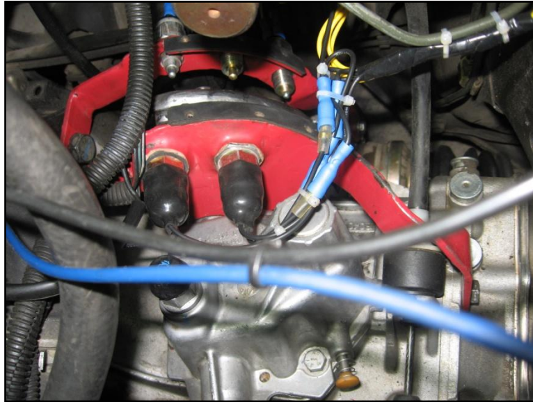
Figura 4.4: Disposición del sensor de marchas
