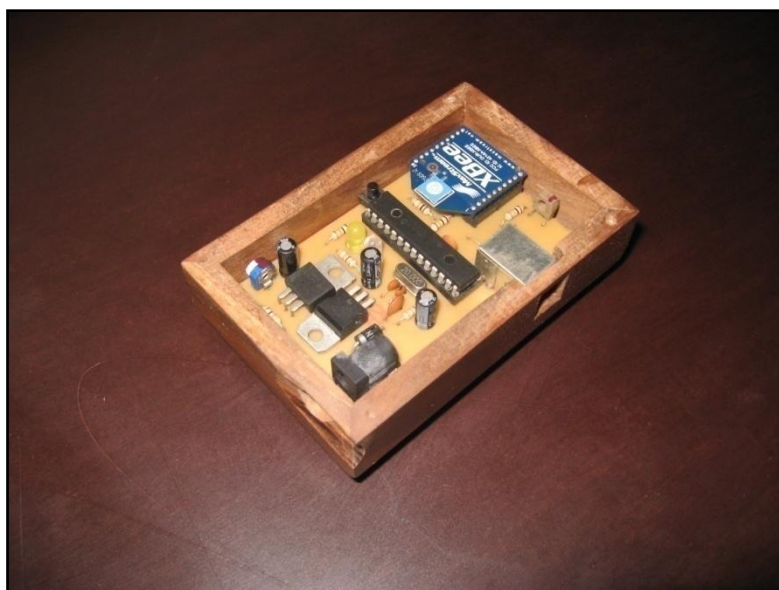
Figura 4.2: Placa terminada del puente ZIGBEE – USB
