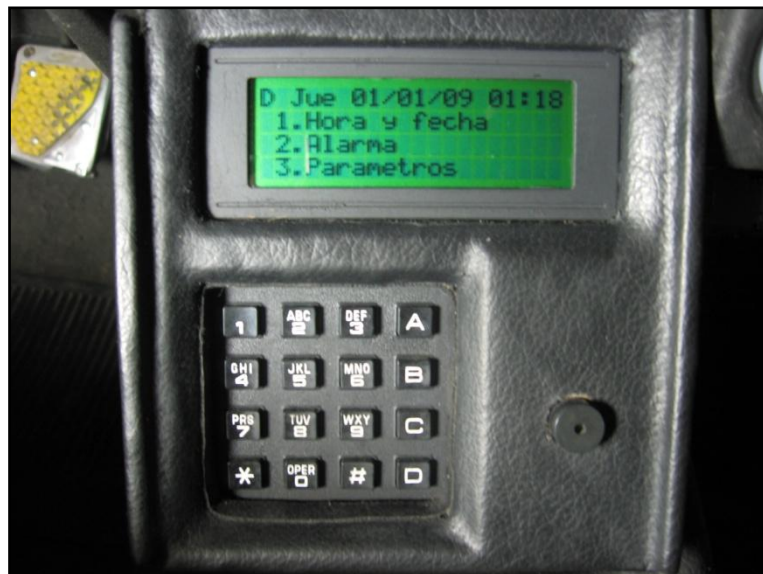
Figura 4.5: Teclado y LCD para configuración
