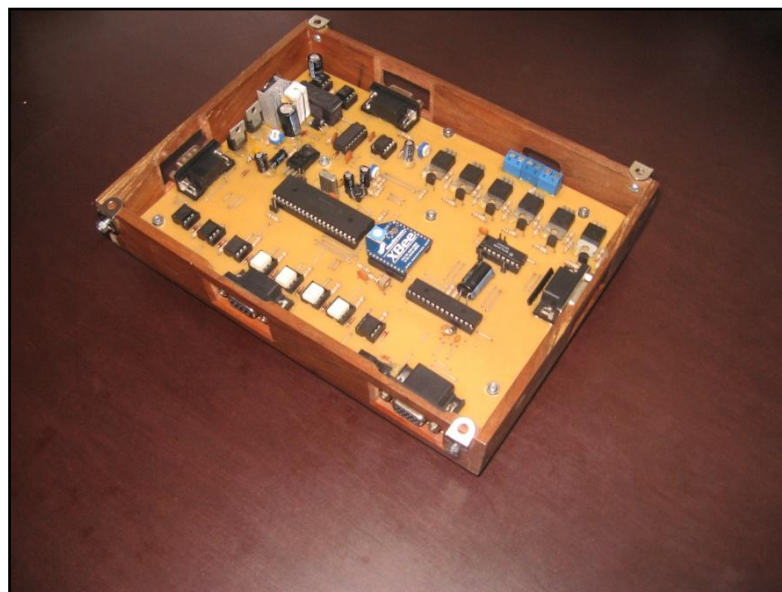
Figura 4.1: Placa terminada del módulo de encendido temporizado
