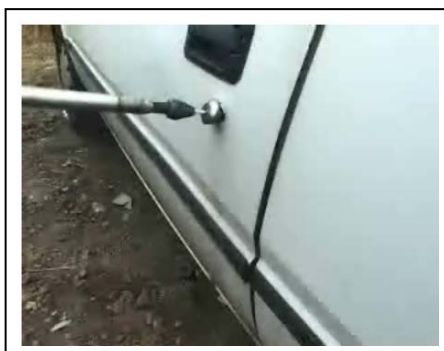
Figura 1.7 - Ejecución para despegar la chapa de la puerta.
