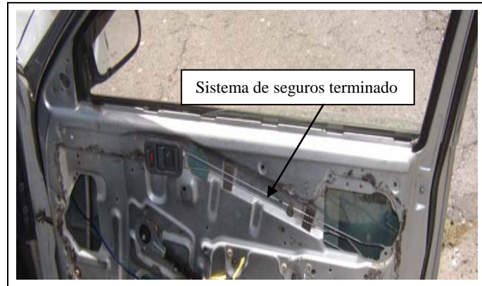
Figura 4.20 - Sistema de seguros eléctrico terminado.
