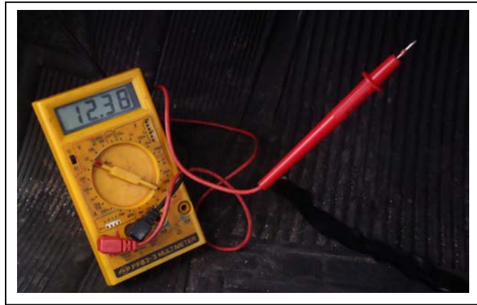
Figura 5.7 - Prueba de voltaje ingreso al módulo.
