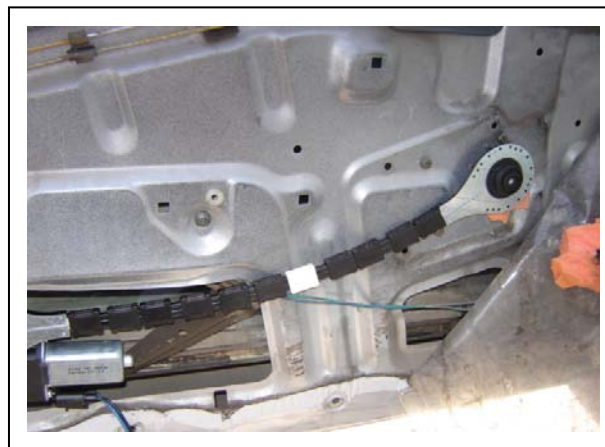
Figura 4.12 - Posición adecuada del gusanillo móvil.
