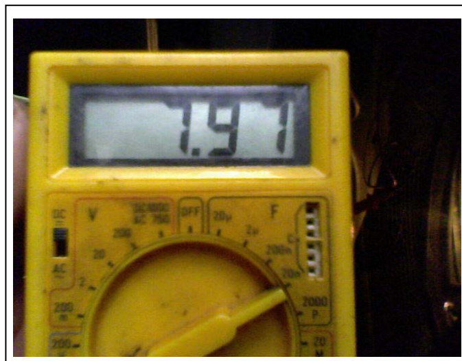
Figura 5.11 - Medición del amperaje motor vidrios el máximo.
