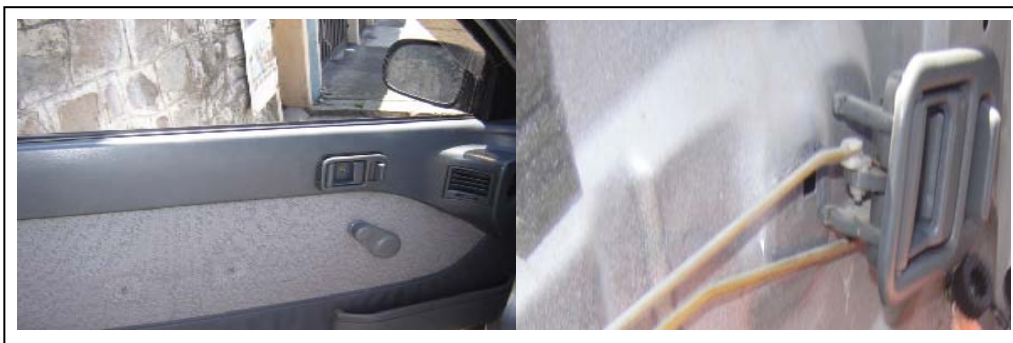
Figura 4.16 - Desmontaje de tapicería y seguros de puertas.
