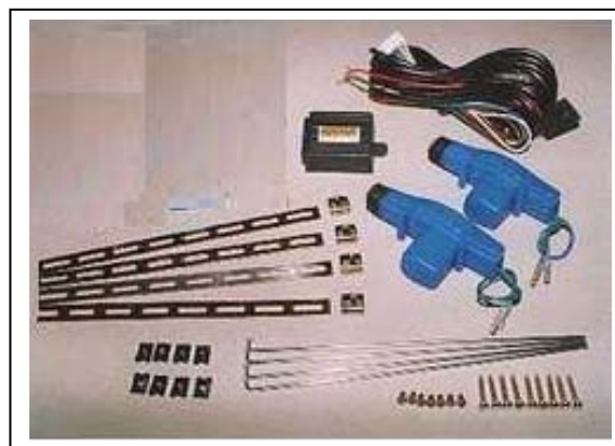
Figura 4.7 - Componentes de los seguros eléctricos
