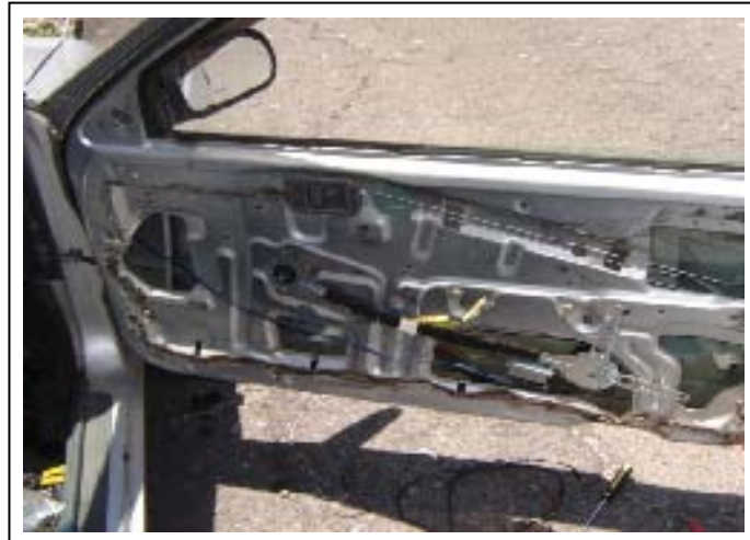
Figura 4.15 - Terminación de la adaptación de vidrios eléctricos.
