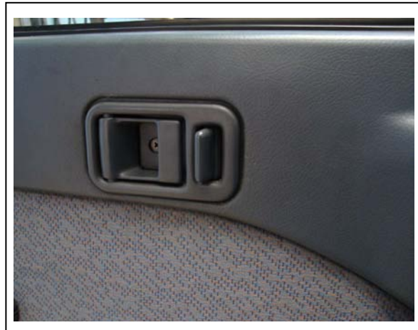
Figura 5.4 - Prueba cierre del seguro de las puertas.
