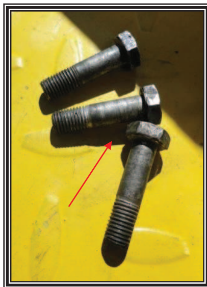
Figura 3.32 Pernos laterales de las fajas del ala derecha
