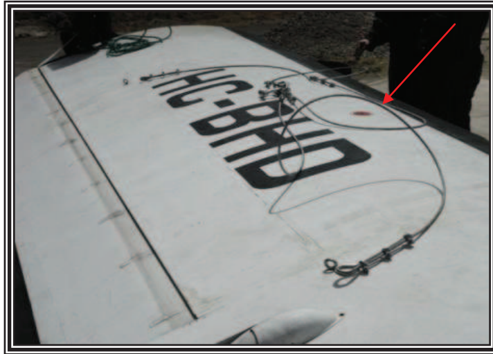
Figura 3.7 Eslinga y Ala derecha del avión Fairchild Fuente: Investigador
