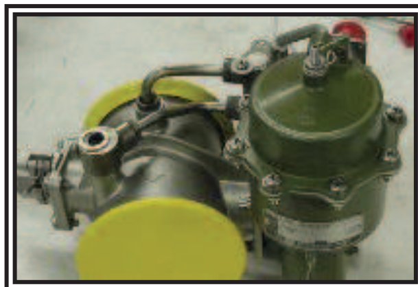
Figura 2.23 Válvulas de combustible
