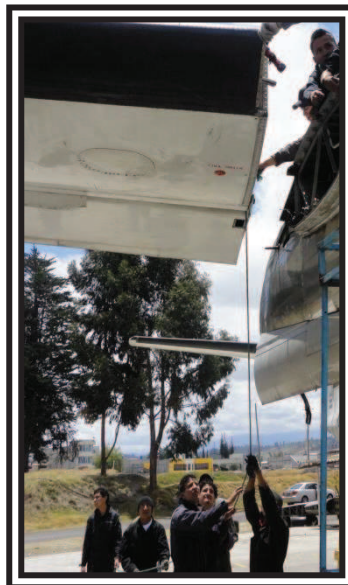
Figura 3.2 Soga colocada en la raíz del ala
