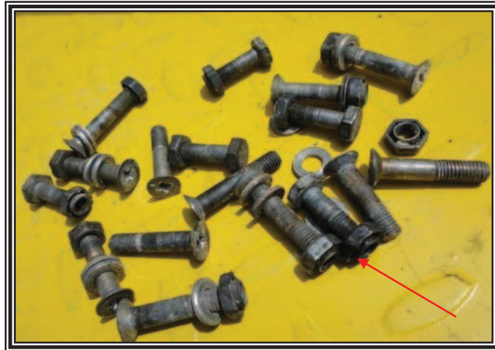
Figura 3.33 Pernos de las fajas del ala del avión
