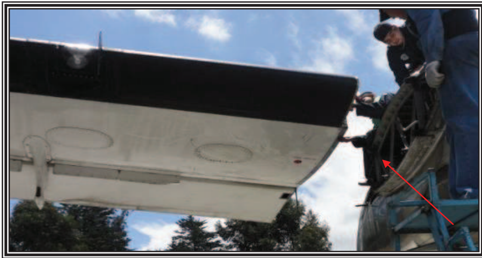
Figura 3.25 Ubicar la raíz del ala en posición
