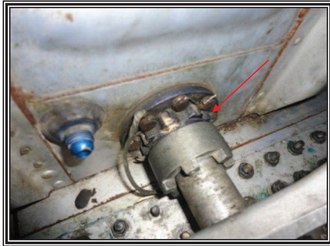
Figura 3.37 Cañerías de combustible
