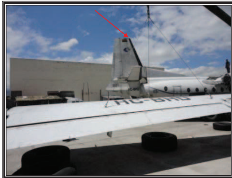
Figura 3.23 Levantamiento del ala derecha de sus soportes
