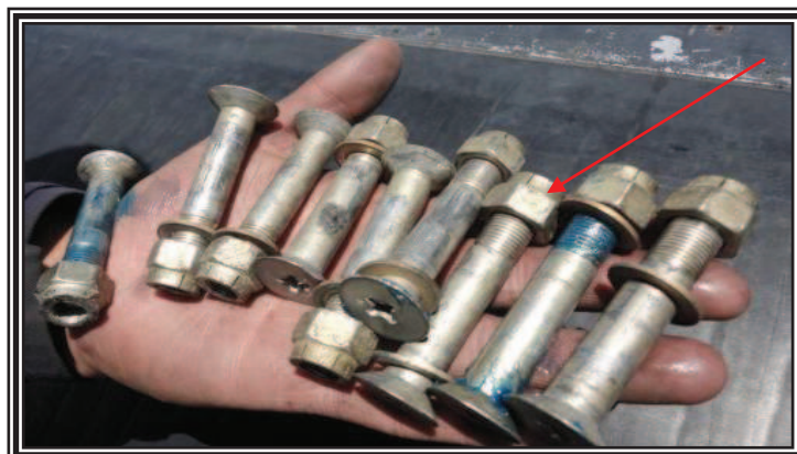
Figura 3,16 Nueve pernos engrasados e inspeccionados
