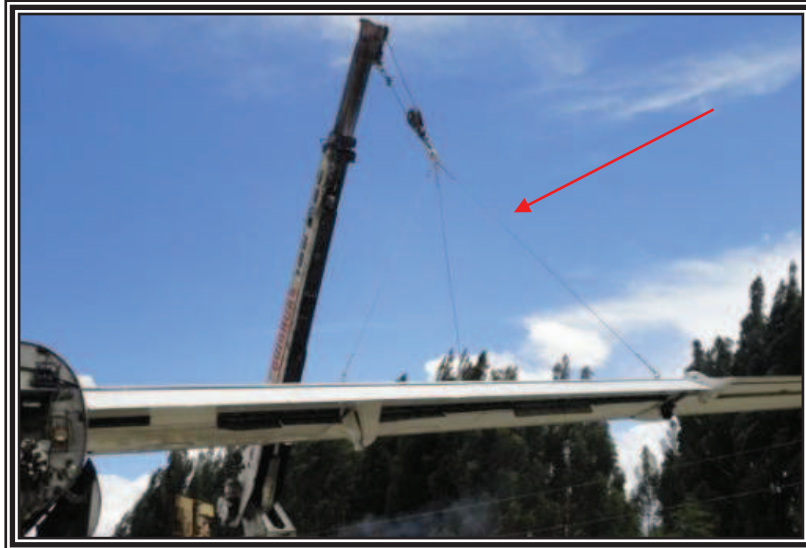
Figura 3.29 Desconexión de la eslinga del ala
