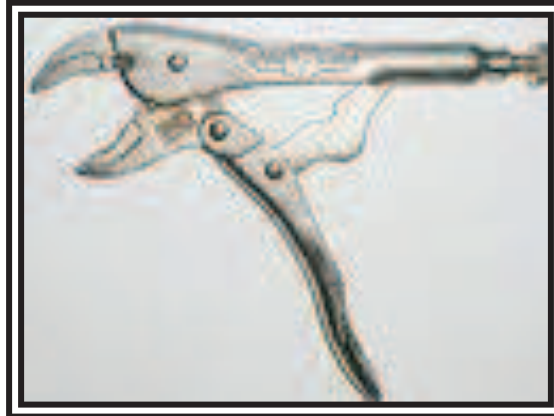
Figura 2.44 Alicates de presión
